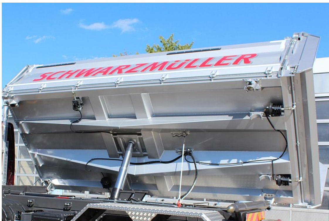
Konstrukce sklápěcí korby tvořená kónickými podélníky trapézového profilu ve vysokopevnostním lehkém provedení s malými podlahovými úseky pro vysokou odolnost proti boulím a vysokou pružností tlumení nárazů
