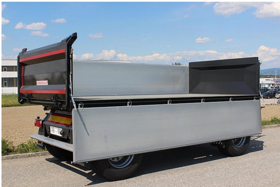
2-nápravový 3-stranný sklápěcí přívěs se sklopnou bočnicí
