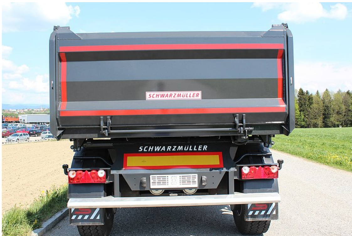
Výkyvná ocelová zadní stěna o síle 4 mm, se zvýšeným uložením čepů a automaticko-pneumatickým uzávěrem
