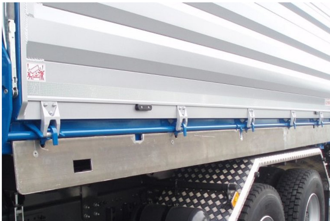
VOLITELNĚ: hliníková výsypná lišta na centrálním ovládní bočnice
