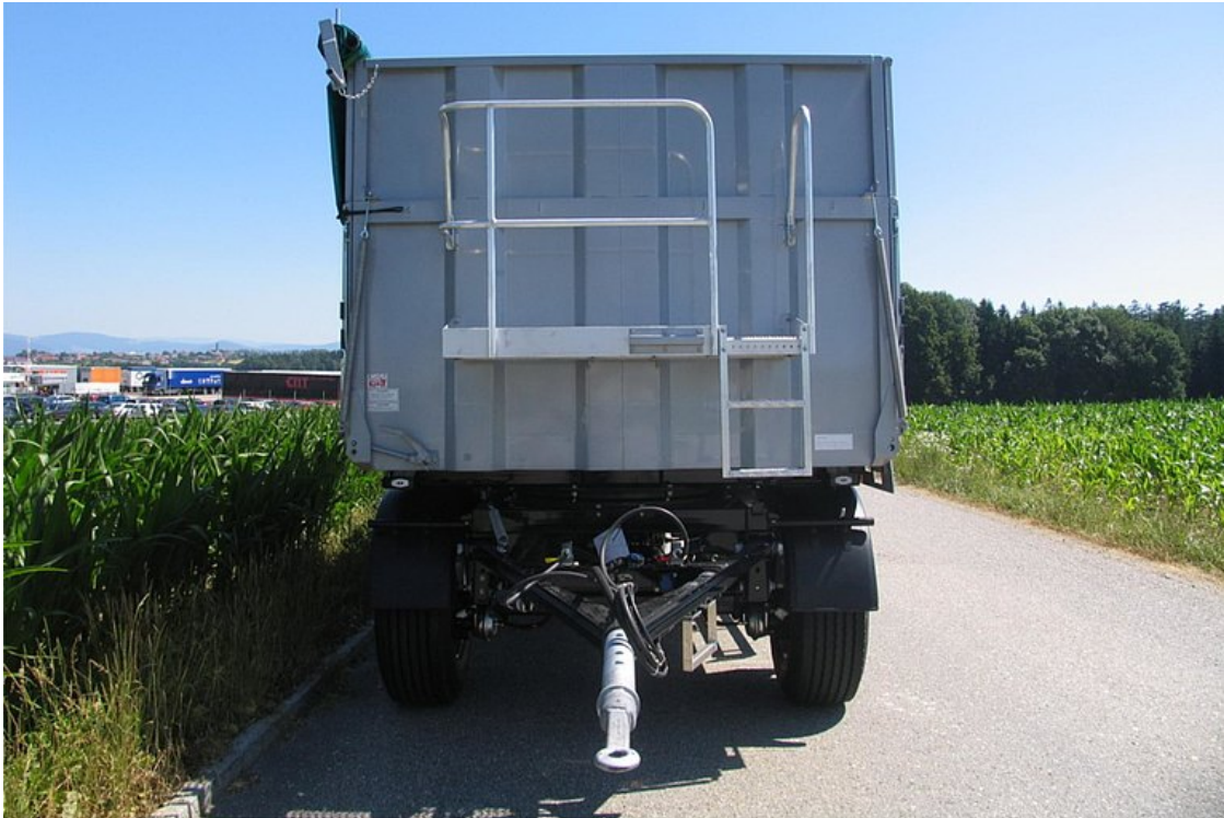
Čelní pohled - ocelová přední stěna & vidlicová tažná oj uložena v silentblocích
