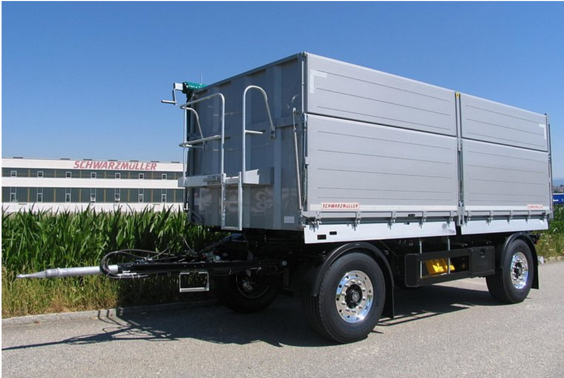
2-nápravový 3-stranný sklápěcí přívěs pro dálkovou přepravu
