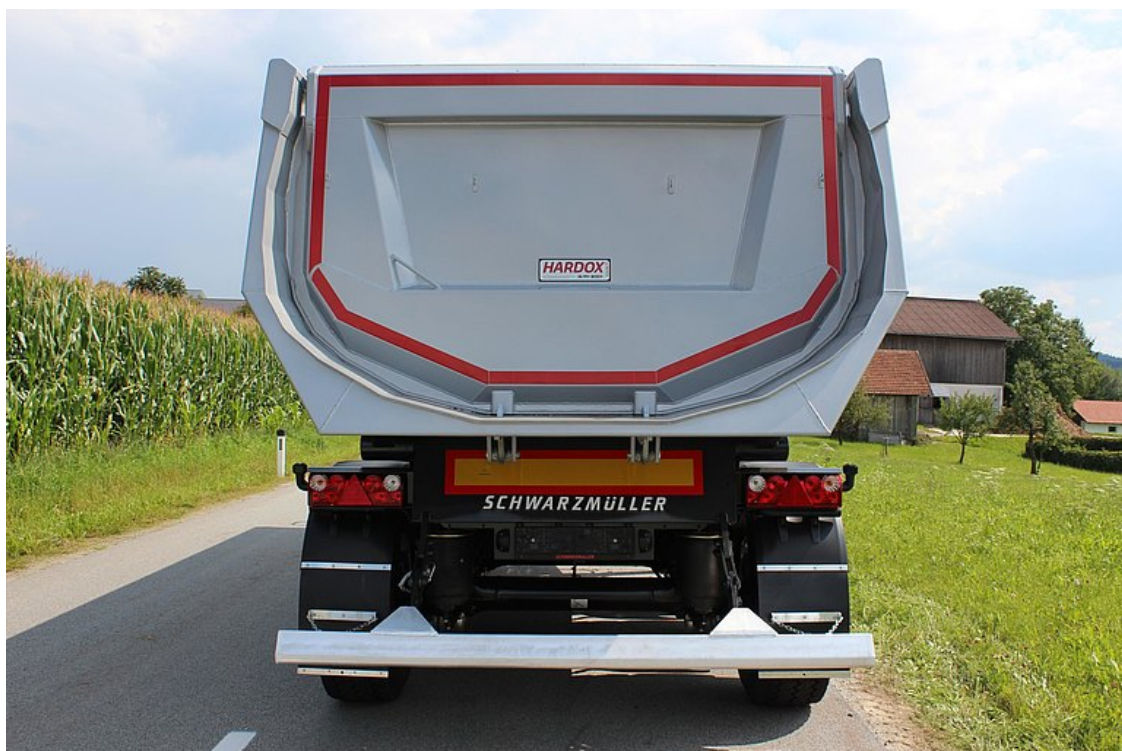
Ocelová zadní stěna = výkyvná se zapuštěným uložením čepů a autom.- mechan. 2-hákovým centrálním uzávěrem
