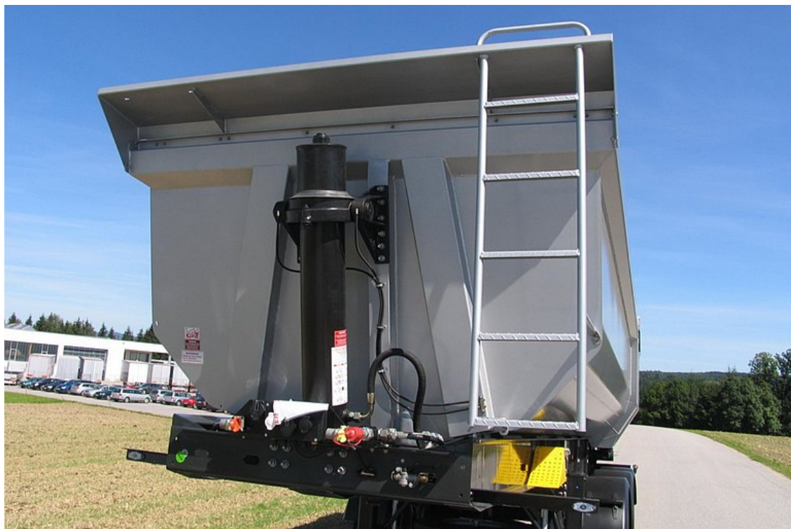
Optimální rozdělení zátěže pomocí konstrukce korby se zešíkmenou přední stěnou
