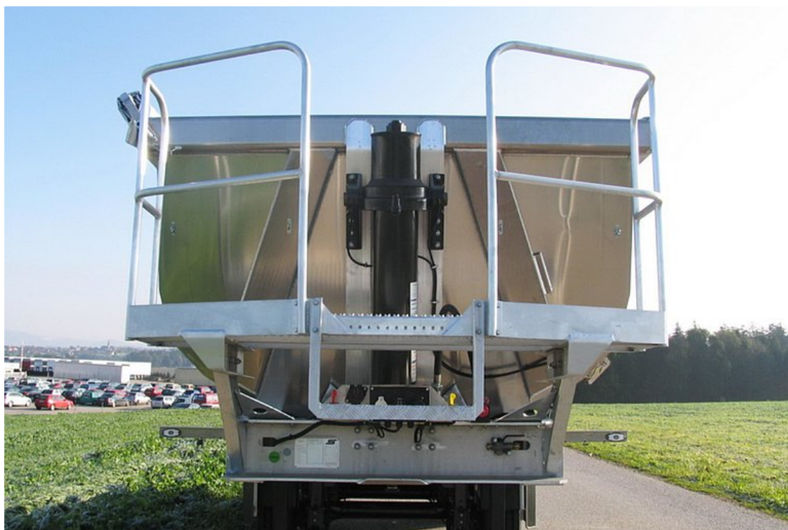
Šikmá přední stěna s tvrdě chromovaným, vysoce kvalitním hydraulickým válcem (hydromotor)
