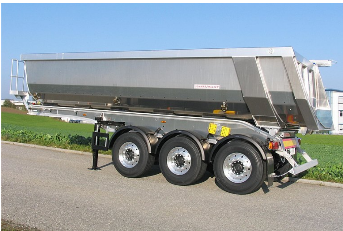
3-nápravový hliníkový sklápěcí návěs s hliníkovou korbou v segmentovém provedení
