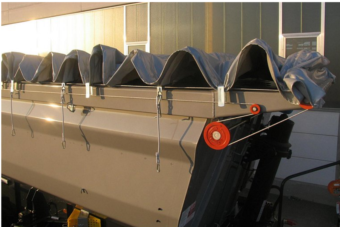
Stahovací střecha - dle výběru - manuální ovládání nebo prostřednictvím elektrického dálkového ovládání
