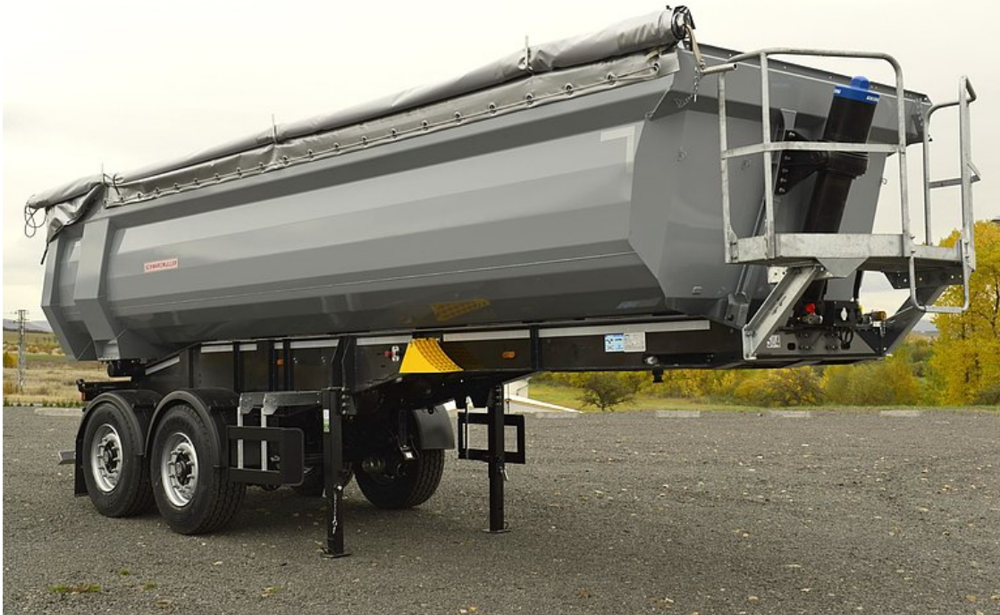
Nejlepší možná ochrana proti nárazům a opotřebení díky speciálně naohýbané hardoxové korbě
