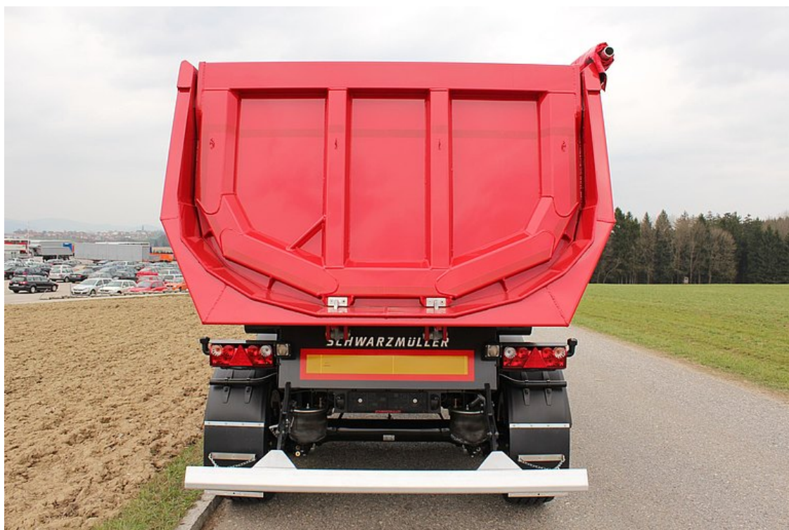
Zadní stěna = výkyvná se zapuštěným uložením čepů a autom.- mechan. 2-hákovým centrálním uzávěrem
