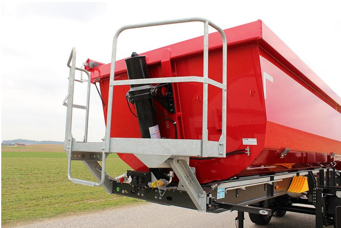
Podesta na přední stěně k ovládání navíjecí plachty
