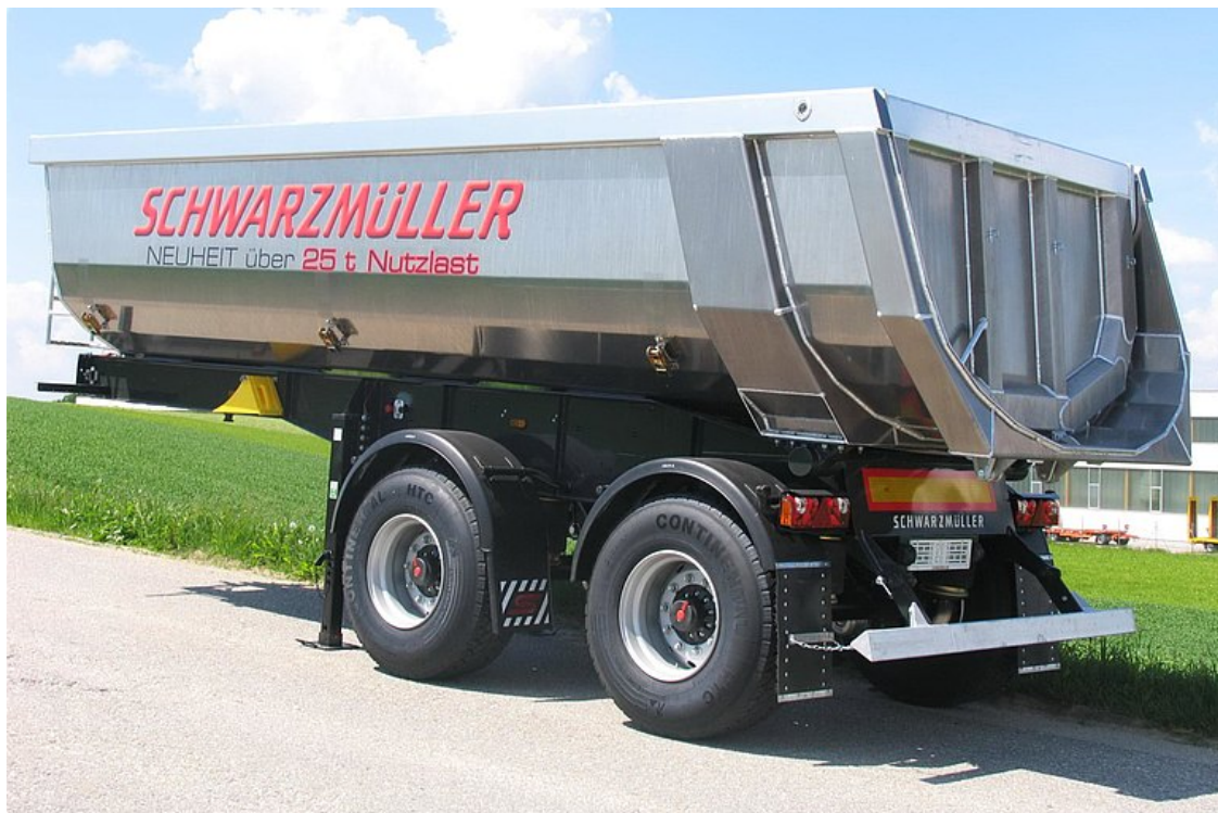
2-nápravový sklápěcí návěs s hliníkovou korbou v segmentovém provedení - rozvor 1.810 mm
