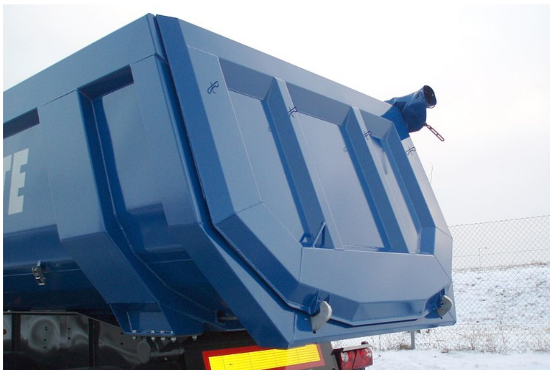
VOLITELNĚ: ocelová zadní stěna umístěná zcela vzadu (dosedá vně muldy) - pro zajištění většího nakládacího objemu
