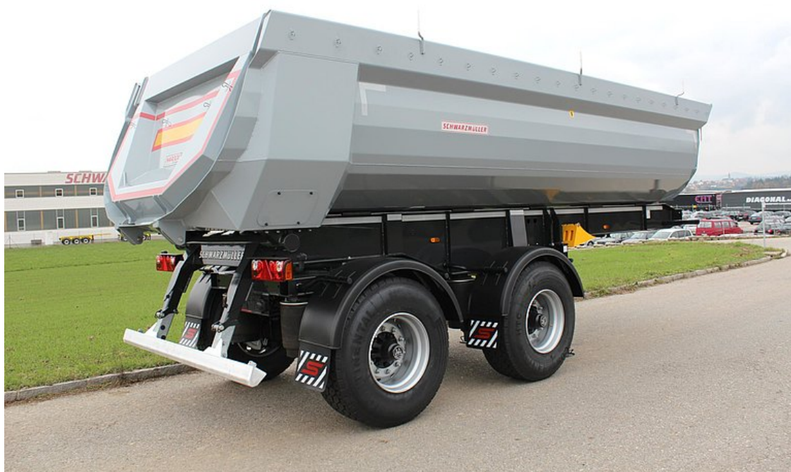
2-nápravový sklápěcí návěs s ocelovou korbou v segmentovém provedení - rozvor 1.810 mm
