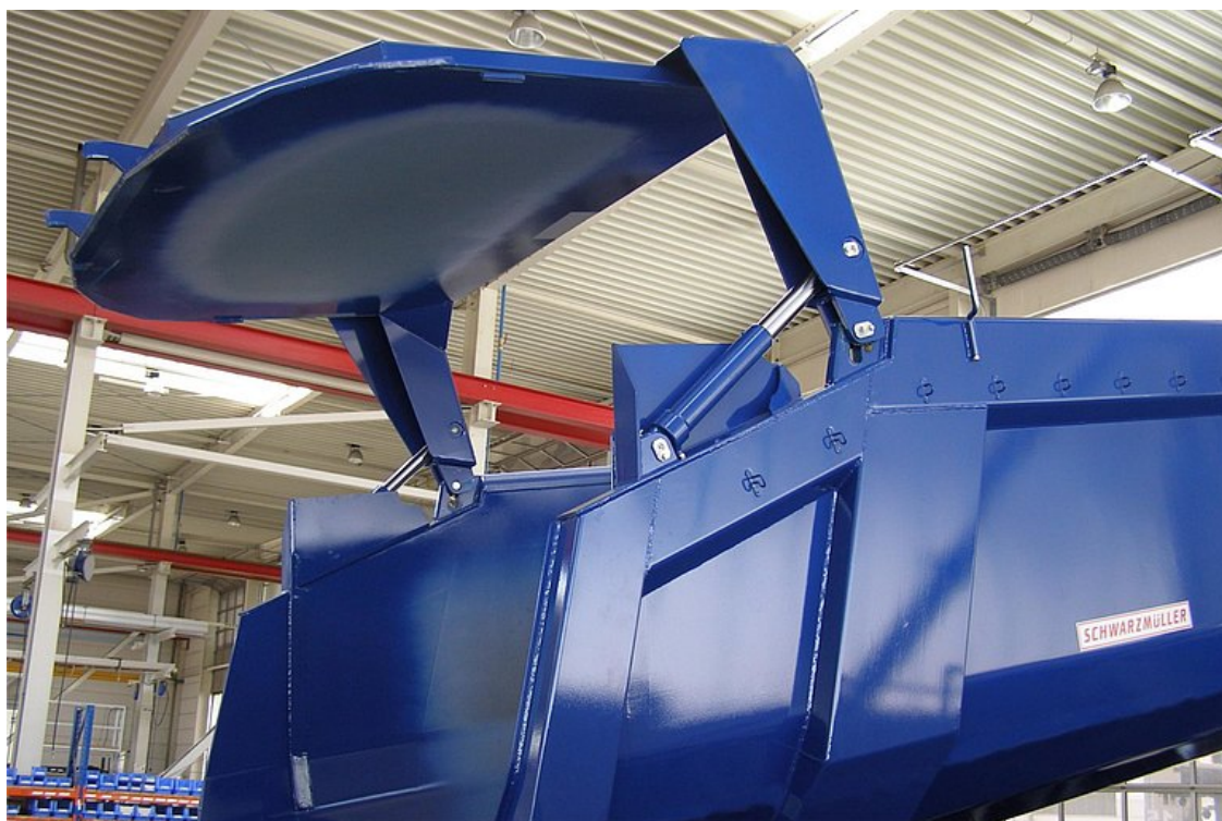
VOLITELNĚ: speciální výkyvná zadní stěna pro extravysoké otevření se zapuštěným uložením čepů a automaticko-hydraulickým ovládáním
