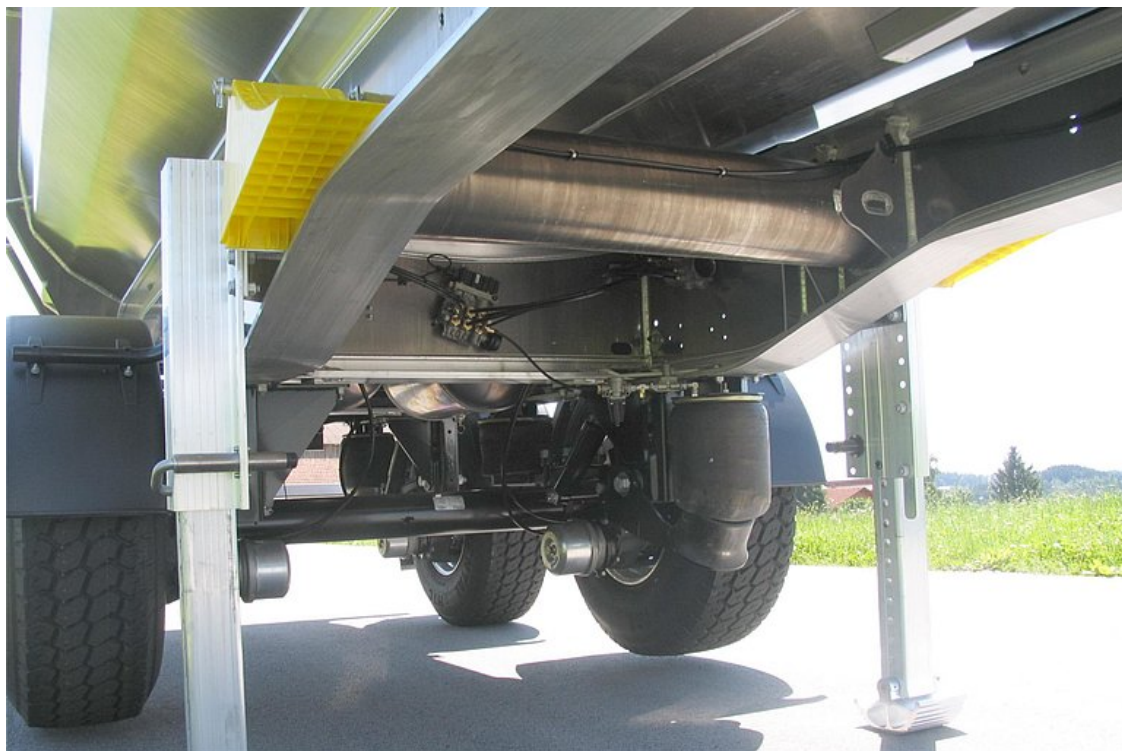
Stabilní a tuhá hliníková konstrukce podvozku s dodatečnými torzními tyčemi = značná úspora hmotnosti
