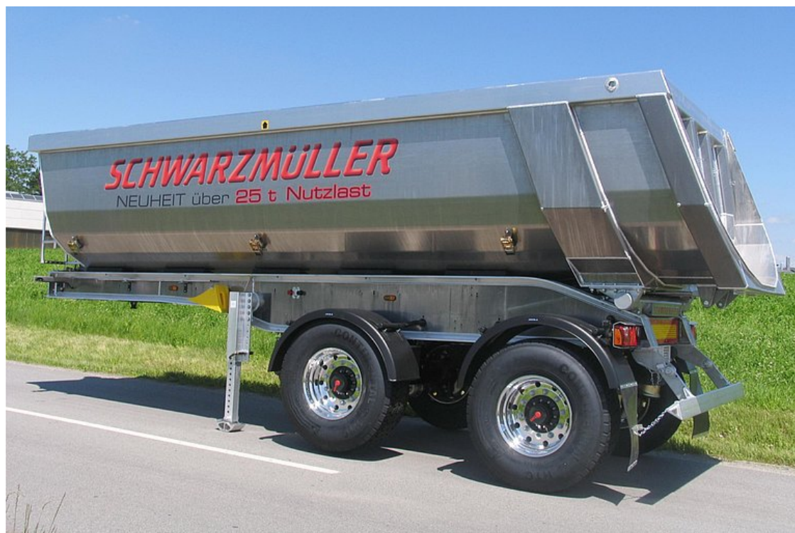
2-nápravový hliníkový sklápěcí návěs s hliníkovou korbou v segmentovém provedení - rozvor 1.810 mm
