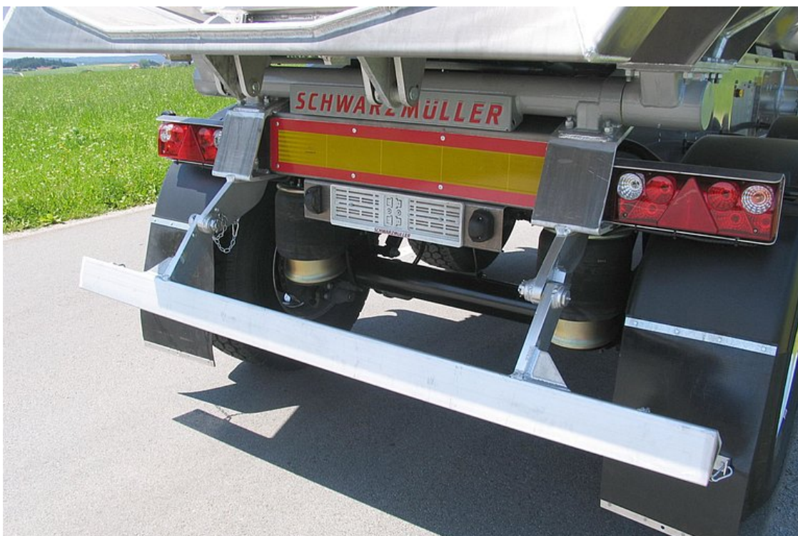
Zadní hliníková trojúhelníková sklopná ochrana proti podjetí (nárazník)
