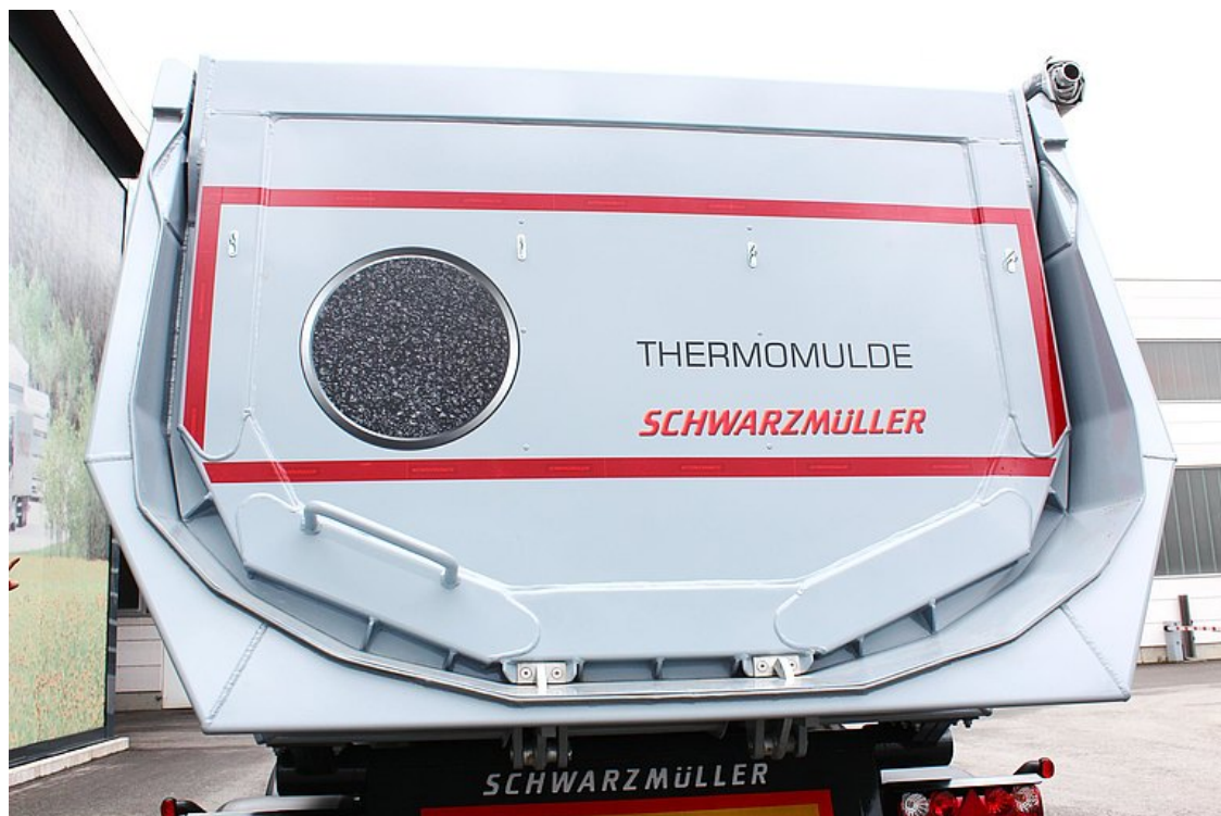
Izolovaná výkyvná zadní stěna se zapuštěným uložením a automatickým, mechanicky ovládaným, centrálním dvouhákovým uzávěrem
