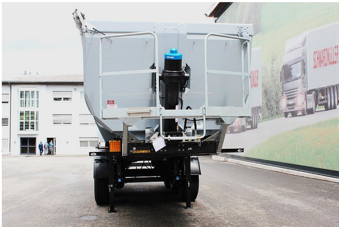
Izolovaná čelní stěna s vysoce kvalitním, tvrdě chromovaným sklápěcím válcem
