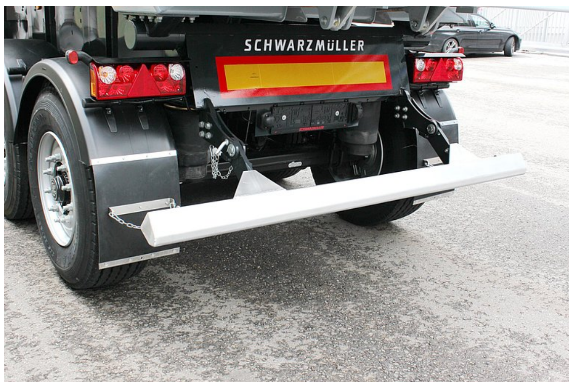
Sklopný zadní nárazník z trapézového hliníkového profilu, volitelně s pneumatickým vyklápěním vzhůru
