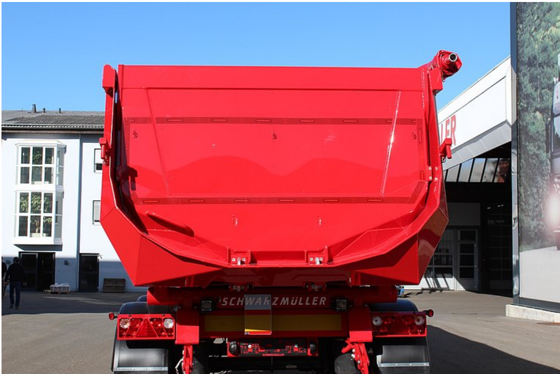
Izolovaná výkyvná zadní stěna se zapuštěným uložením a automatickým, mechanicky ovládaným, centrálním dvouhřávkovým uzávěrem
