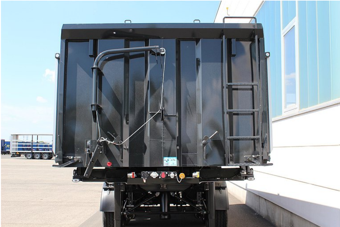
Pevná přední stěna z ocelového plechu s vázacími očky, žebříkem a třmeny
