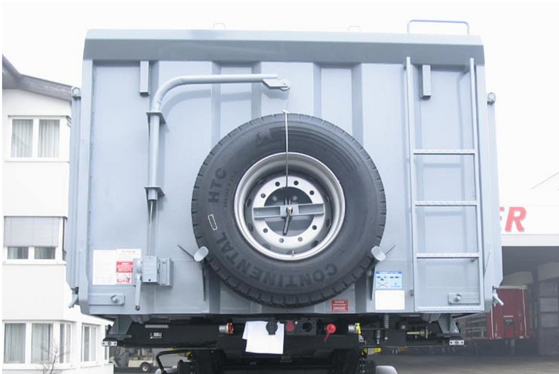
VOLITELNĚ: držák pro rezervní kolo s otočným jeřábem a navijákem na předním čele
