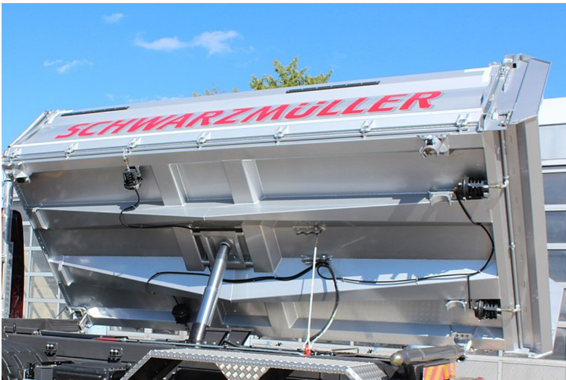
Kónické podélníky trapézového profilu ve vysokopevnostním lehkém provedení s malými podlahovými úseky pro vysokou odolnost proti bouřím a vysokou pružností tlumení nárazů
