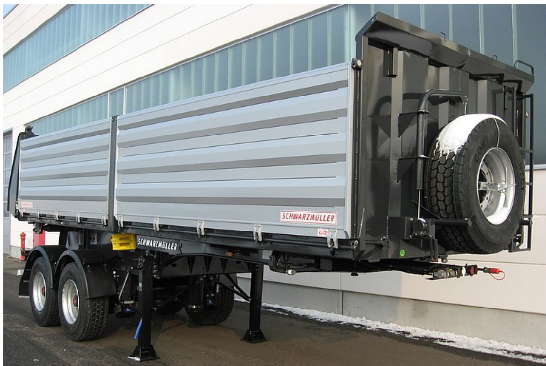
Dvounápravový třístranný sklápěcí návěs - stavební provedení
