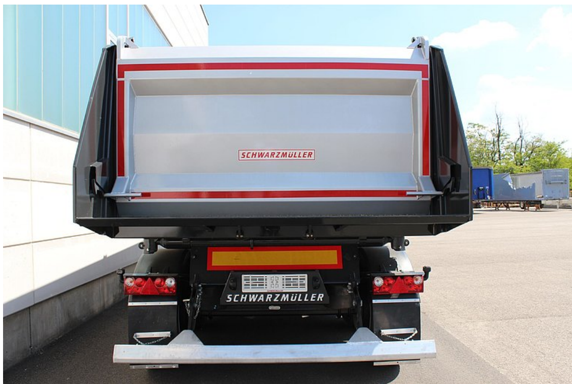
Zadní stěna z ocelového plechu, výkyvná se zvýšeným uložením čepů a automaticko-pneumatickým uzávěrem
