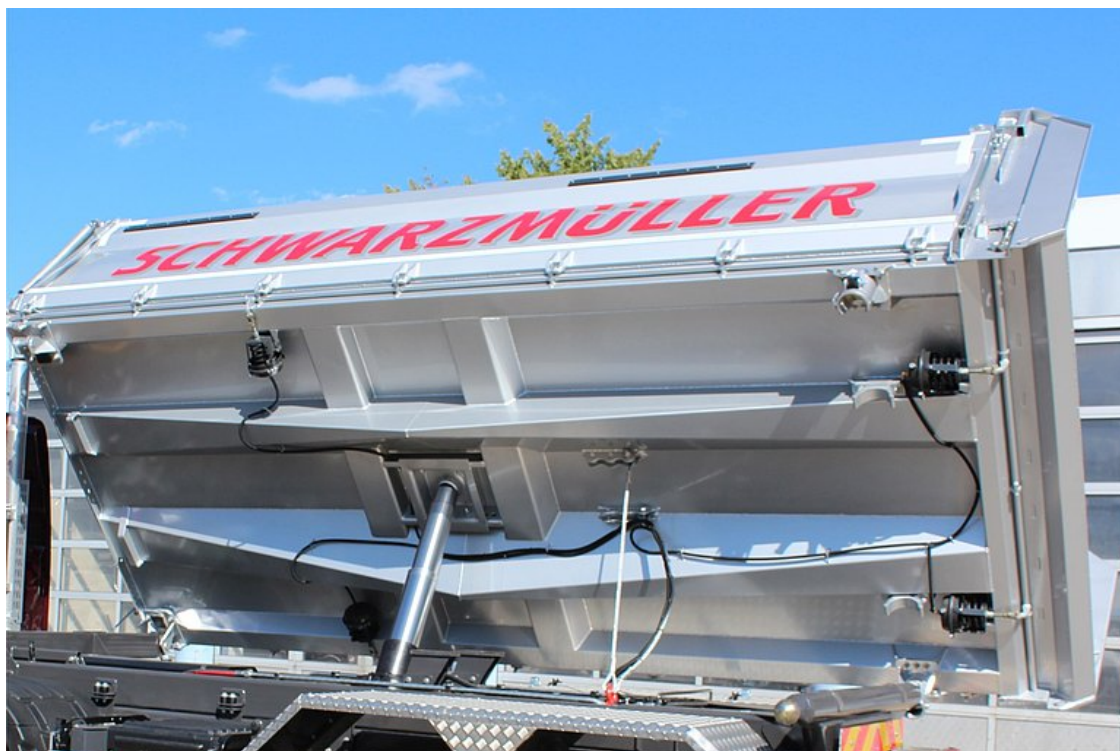
Kónické podélníky trapézového profilu ve vysokopevnostním lehkém provedení s malými podlahovými úseky pro vysokou odolnost proti boulím a vysokou pružností tlumení nárazů
