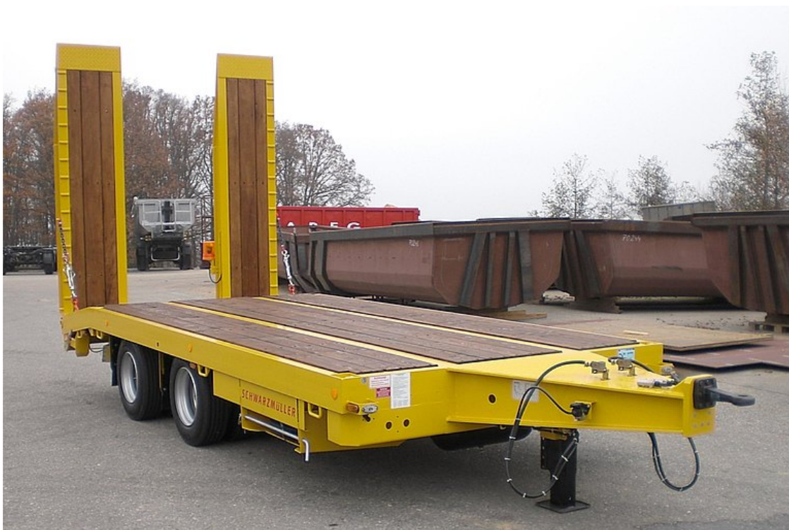
Nízkoložný přívěs s centrálními nápravami a rovnou nakládací plochou
