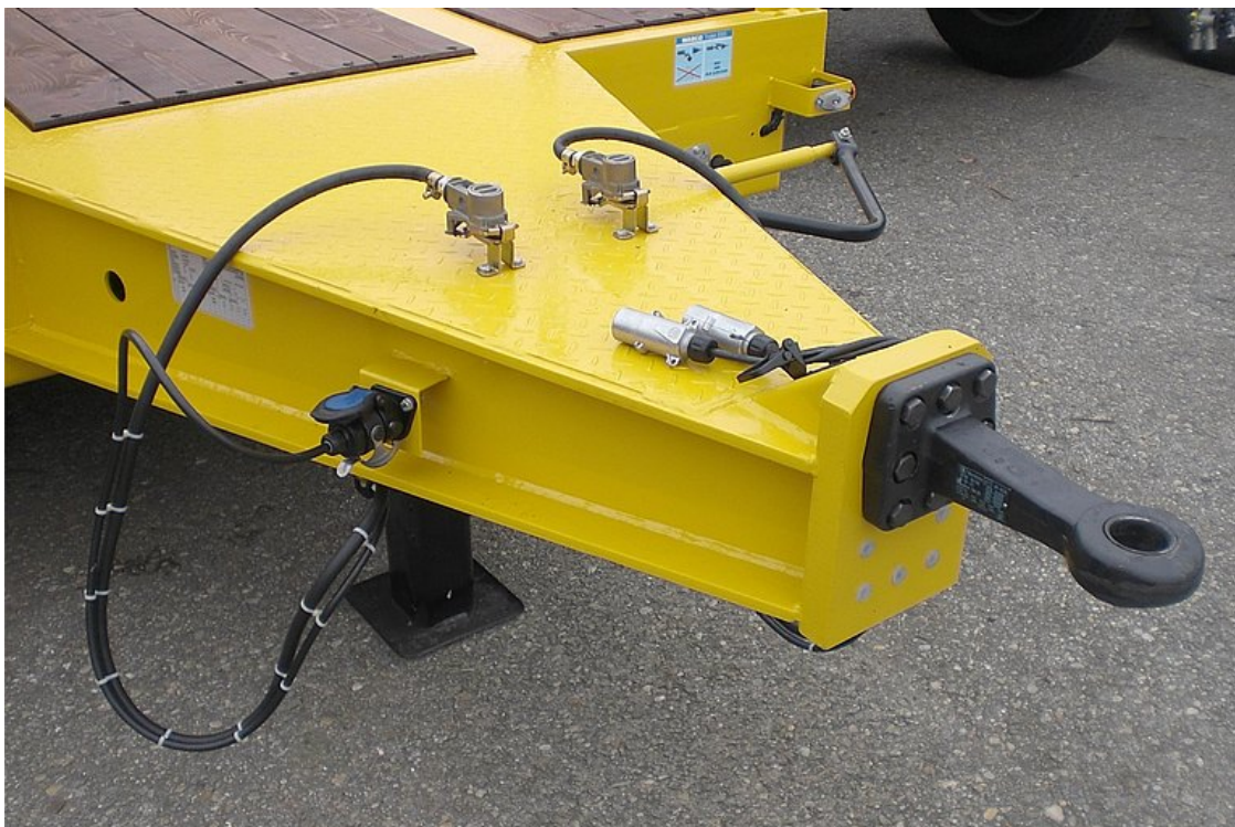
Tažná oj v úrovni ložné plochy, se šroubovacím tažným okem
