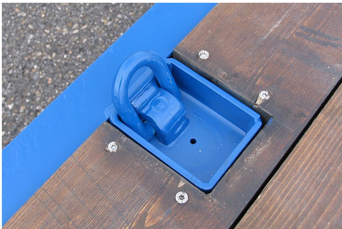
V podlaze zapuštěná podlahová oka stejně jako kotevní třmeny ve vnějším rámu pro optimální zajištění nákladu
