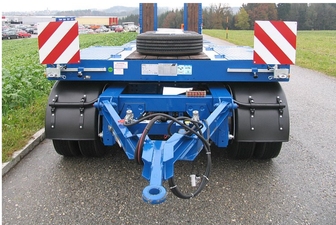
Přední zalomená plošina s úložnými schránkami a výsuvnými varovnými tabulemi pro převoz nadměrně širokých nákladů
