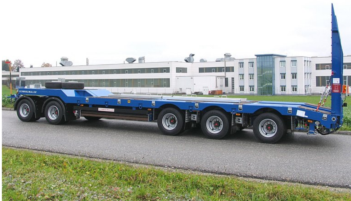
5-nápravový nízkoložný přívěs se zalomeným rámem
