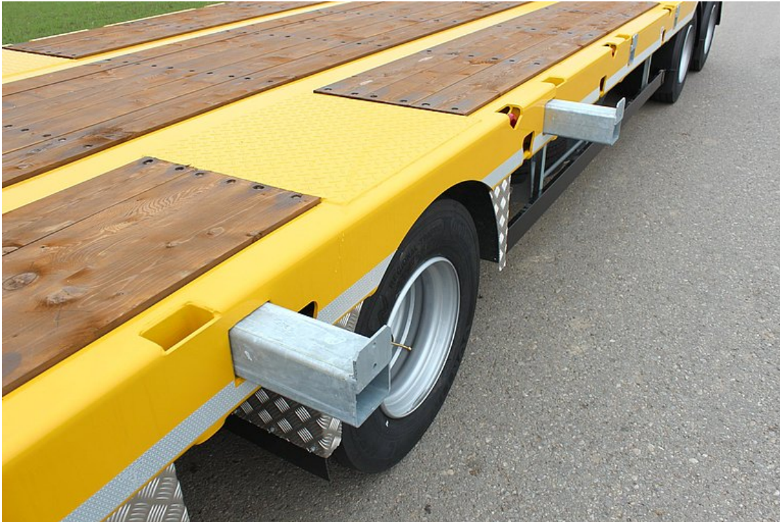
Výsuvné rozšíření oboustranně v oblasti ložné plochy a zkosené zadní části, vč. dřevěných fošen pro přepravu nadměrně širokých nákladů
