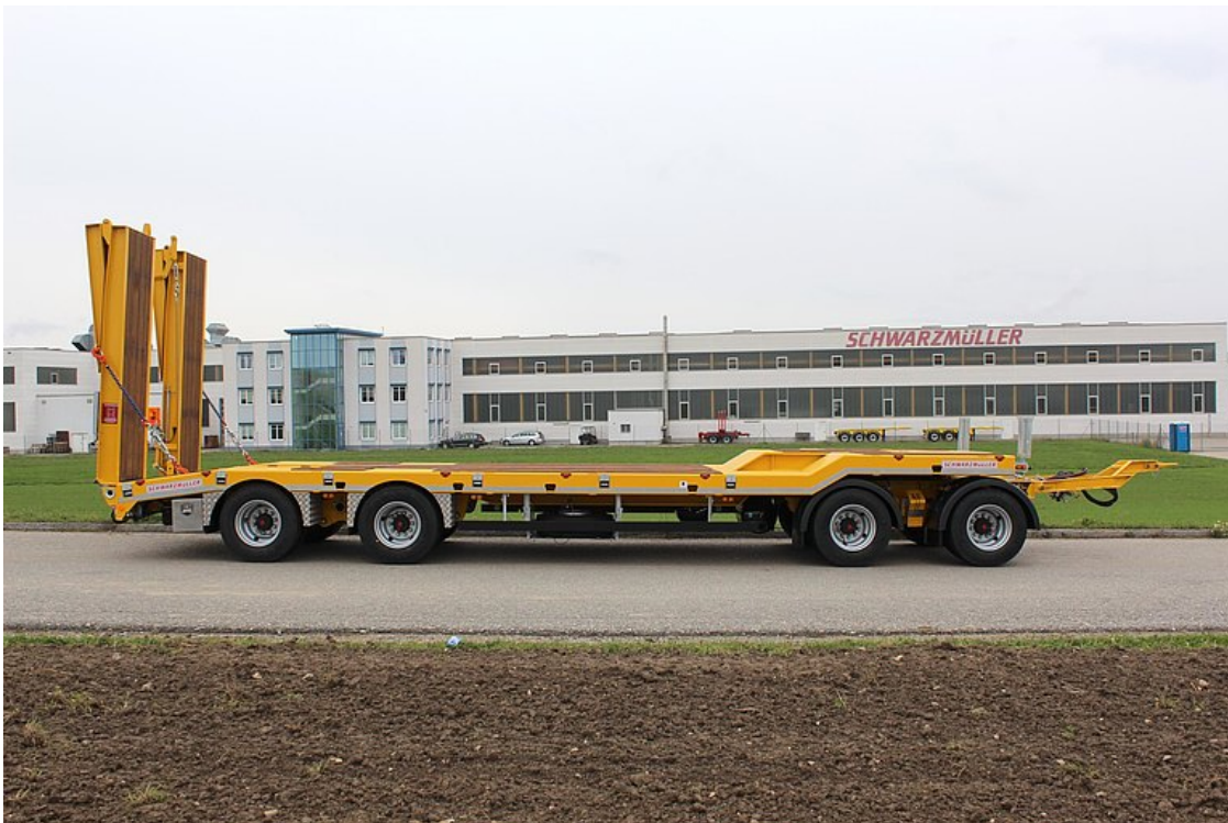
Čtyřnápravový nízkoložný přívěs se zalomeným rámem
