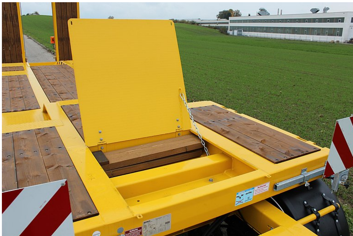
Schránka na příslušenství se sklopným víkem ve zvýšené části vpředu
