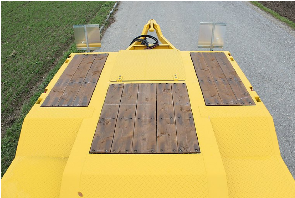
Vpředu zvýšená plošina včetně zalomení rámu vozidla, rohy zešikmené
