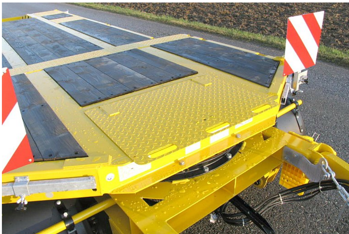
Přední zalomená plošina s úložnou schránkou vč. víka
