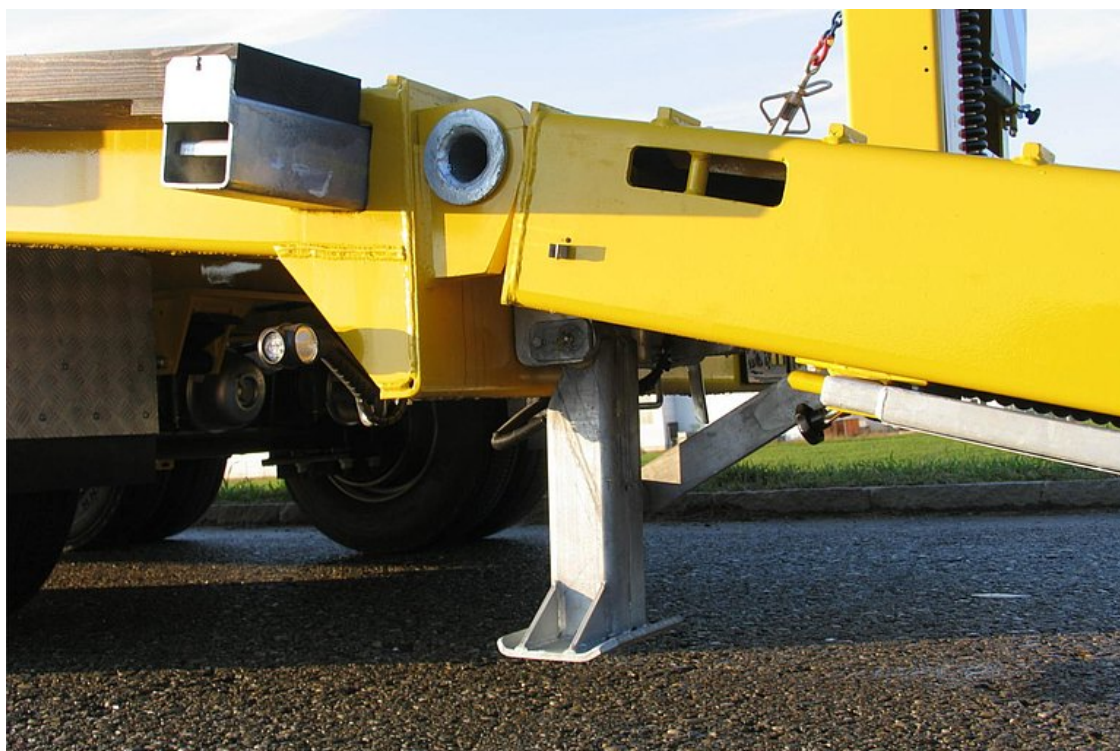
Vzadu na nájezdových rampách resp. na konci rámu automaticky sklopné opěry
