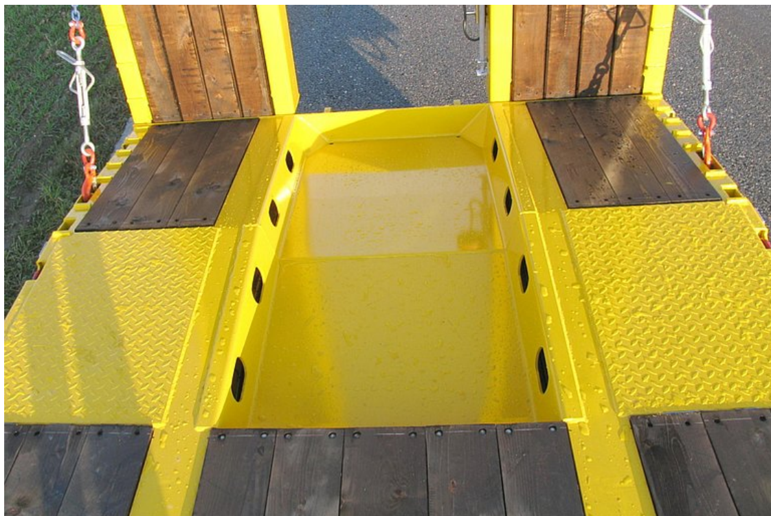
Mulda pro lžící bagru - vybrání vzadu mezi podélníky
