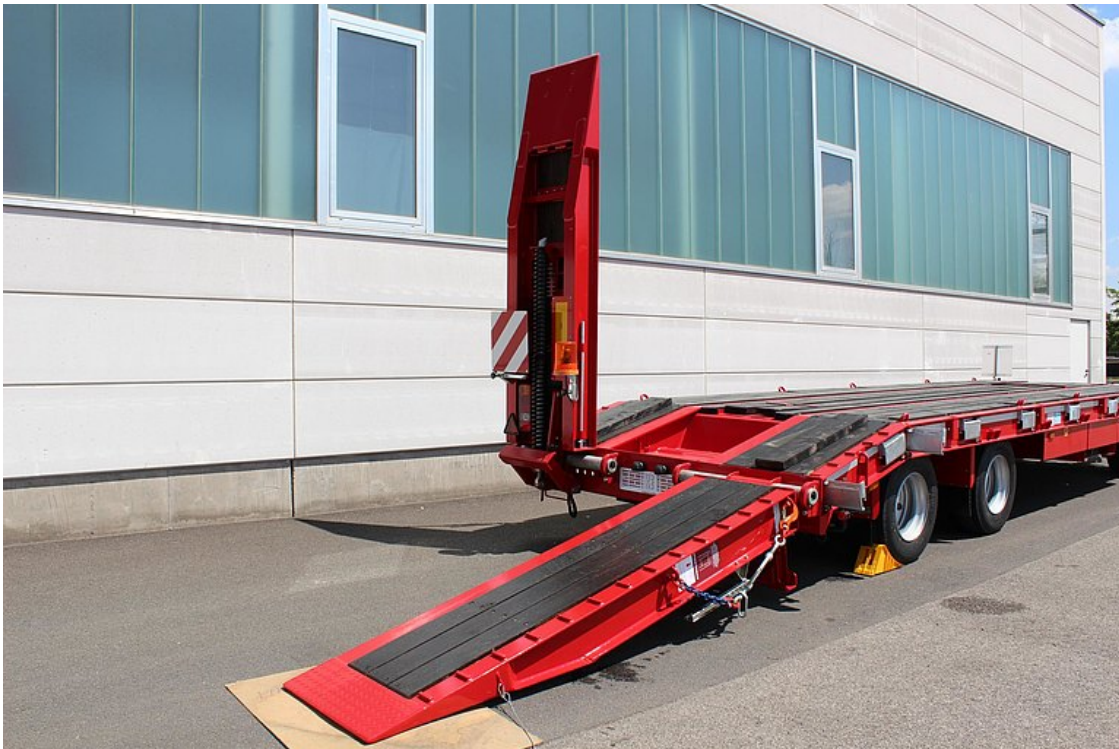
2 sklopné 1-dílné nájezdové rampy s vyložením z tvrdého dřeva
