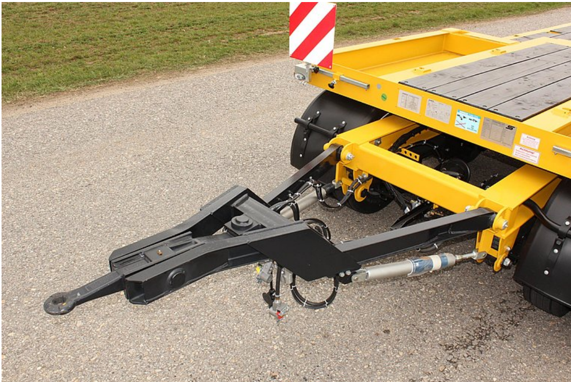
Zalomená tažná oj s vysokozátěžovým okem 40 + 50 mm
