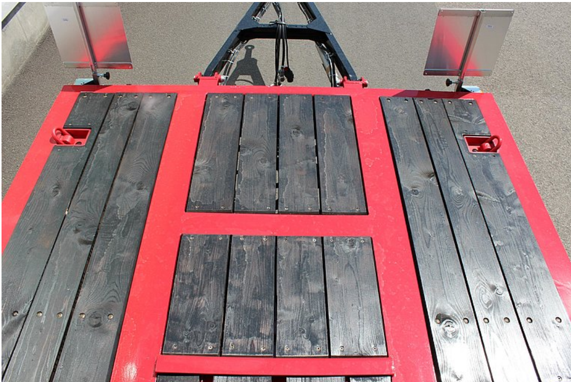
Impregnovaná podlaha z měkkého dřeva, přechínající nad profil rámu
