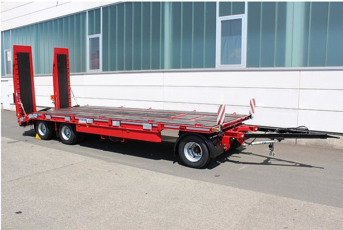
Třínápravový nízkožný přívěs s rovnou plošinou
