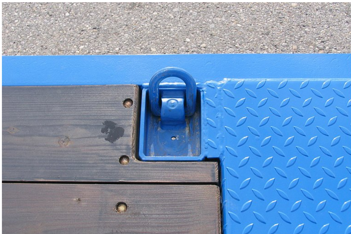
2 páry zapuštěných podlahových kotevních na plošině
