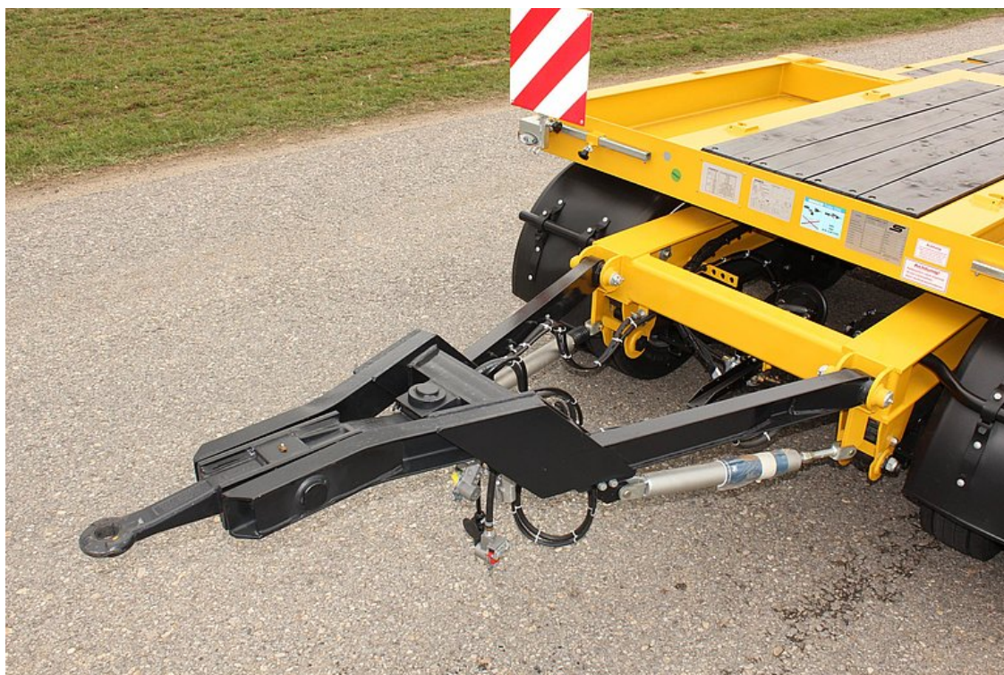
Zalomená tažná oj s vysokožátěžovým okem 40 + 50 mm
