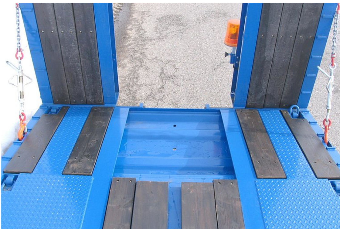
VOLITELNĚ: mulda pro lžici bagru - vybrání vzadu mezi podélníky
