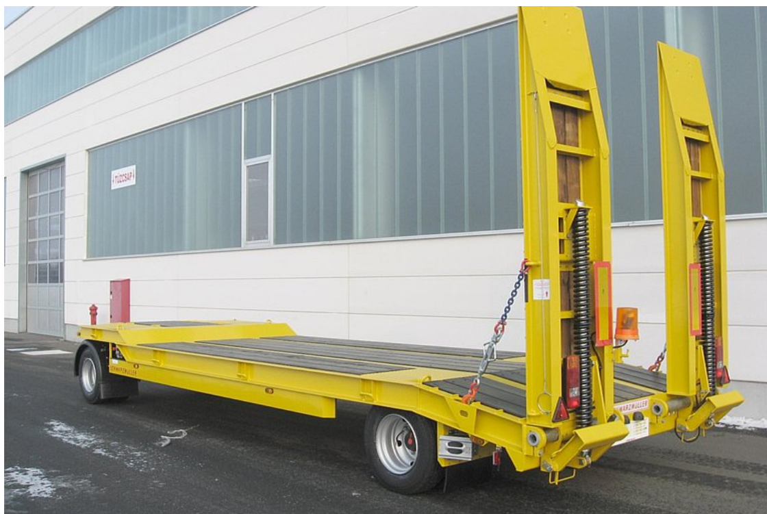
Dvounápravový nízkoložný přívěs se zalomením rámu
