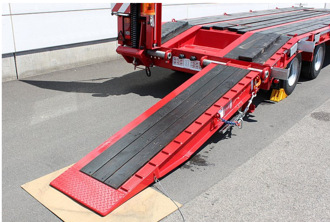
Nájezdové rampy s vyložení z tvrdého dřeva a navařenými čtyřhrany
