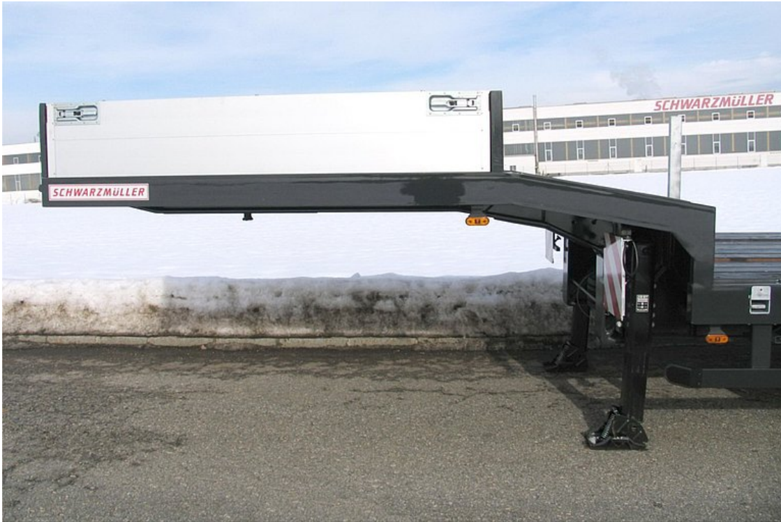
Vpředu zvýšená zalomená plošina vč. nasazovacích bočnic
