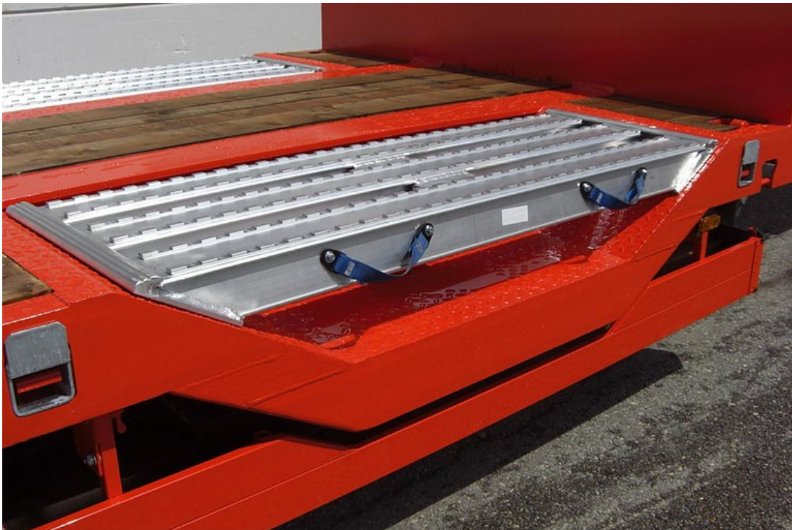
VOLITELNĚ: vybrání pro kola pro přepravu speciálních vozidel
