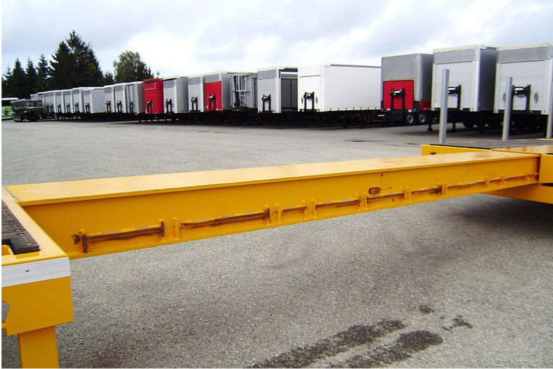
Roztahovatelný centrální rám, více možností nastavení délky, s pneumatickým zajištěním
