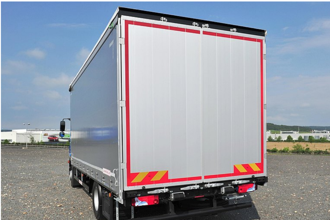
Vzadu našroubovaný portál s hliníkovými rohovými sloupky a s dvoukřídlými vraty přes celou vnitřní výšku
