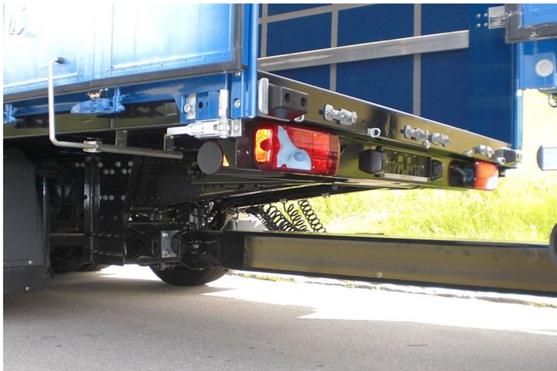
Speciální spojovací zařízení pro tandemový přívěs (s centrálními nápravami) - pro krátký rozestup mezi nástavbou a přívěsem
