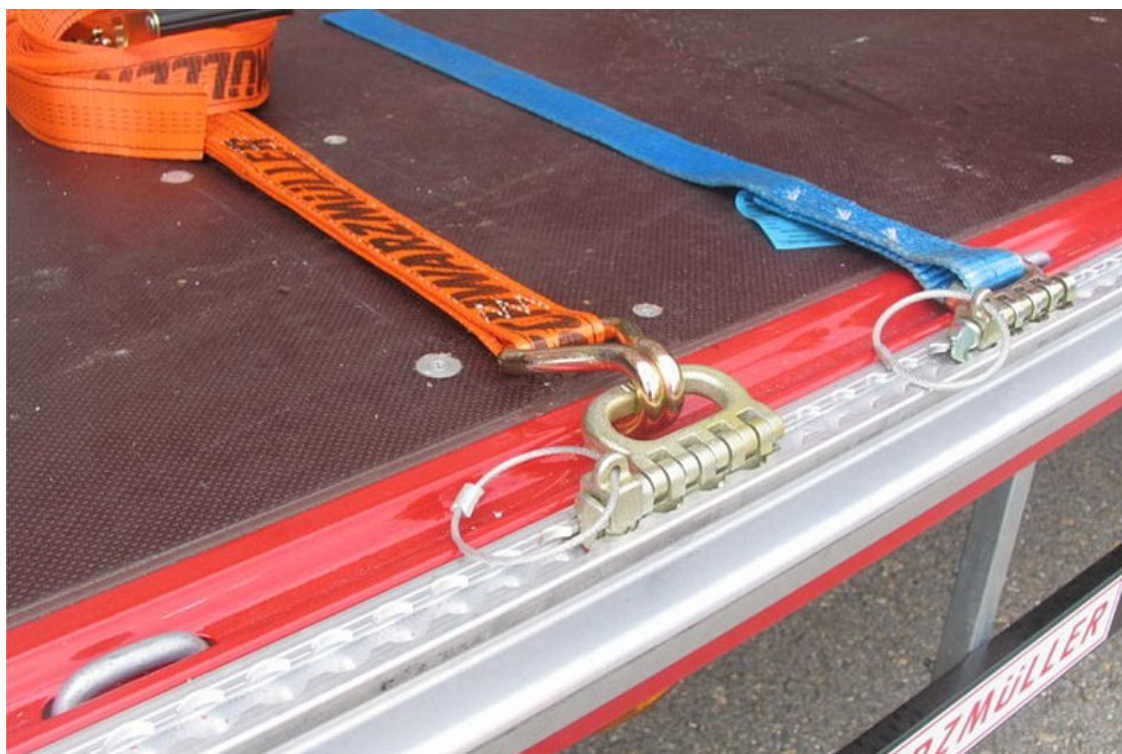
VOLITELNĚ: variabilní zajištění nákladu pomocí přišroubovaného kotevního systému (kotevní lišta Airline, kombinovaná ochranná lišta s kotevními otvory)
