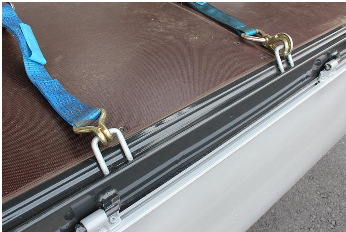
Vnější rám se zapuštěnými 2,5 t kotevními třmeny
