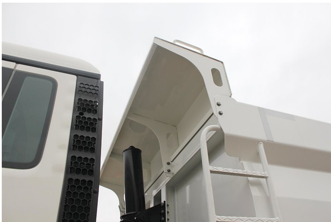
Přední stěna se zvýšeným ochranným kšiltem
