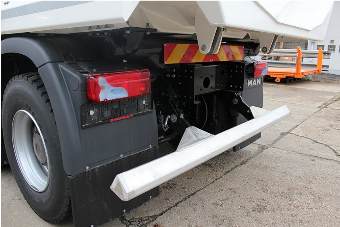
VOLITELNĚ: zadní hliníková sklopná ochrana proti podjetí (nárazník)
