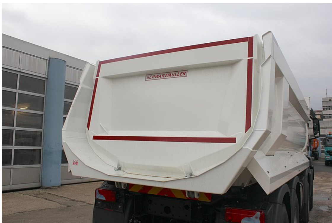
Ocelové zadní čelo = výkyvné se zapuštěným uložením
