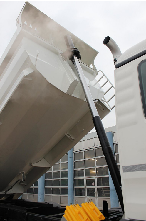
Tvrdě chromovaný, vysoce kvalitní hydraulický válec (hydromotor)
