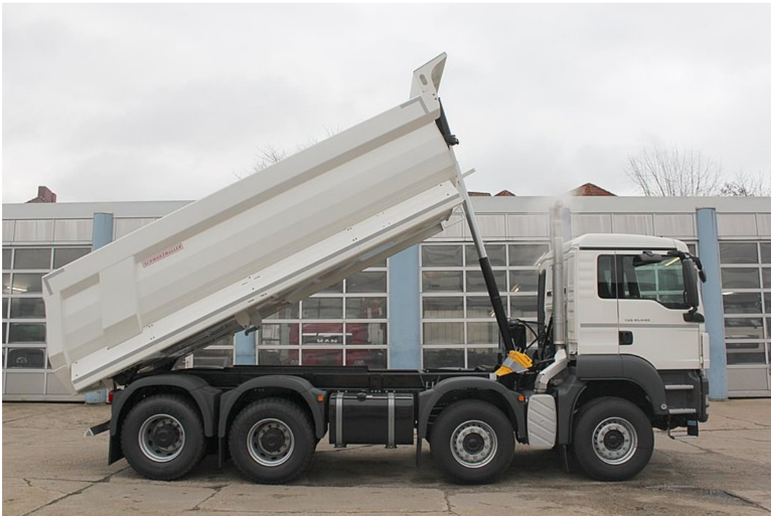
Sklopěcí nástavba s ocelovou korbou v segmentovém provedení na 4-nápravový podvozek
