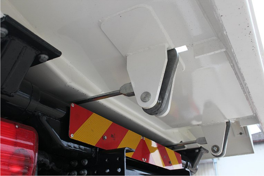
Automatický, mechanický uzávěr zadního čela
