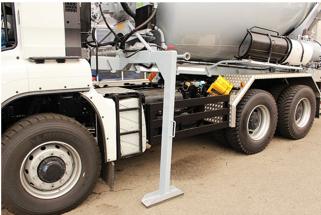
Přední opěrné nohy pro rychlou a jednoduchou výměnu nástavby
