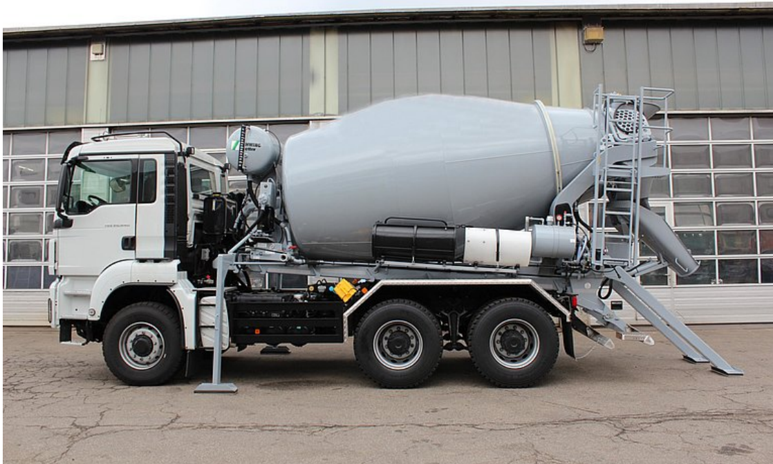
Rychloupínací výměnná 3-stranná sklápěcí nástavba - domíchávač betonu
