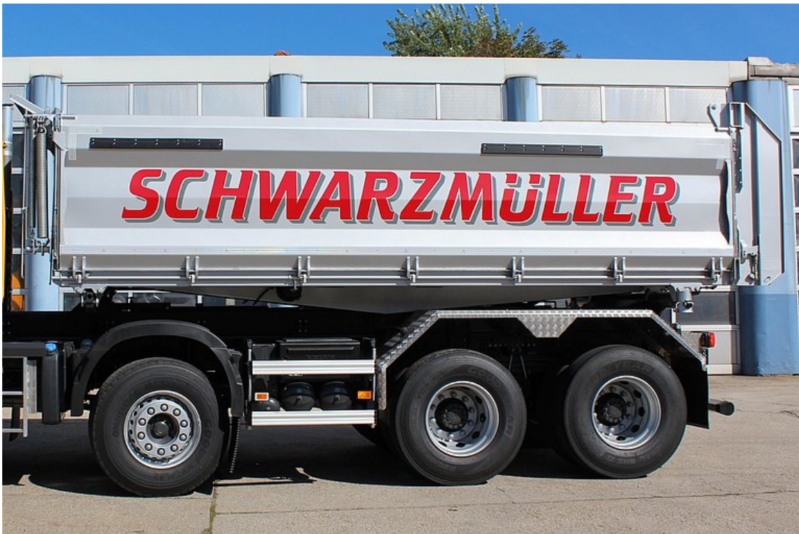
VOLITELNĚ: zesílené ocelové bočnice v membránovém provedení
