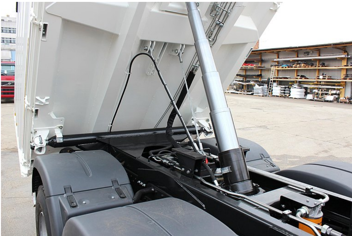
Tvrdě chromovaný, vysoce kvalitní hydraulický válec (hydromotor)
