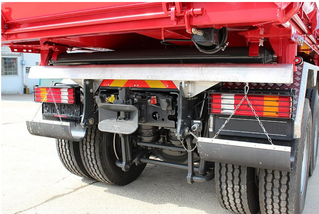
VOLITELNĚ: sklopný hliníkový nárazník, s nájezdovým profilem pro finišér
