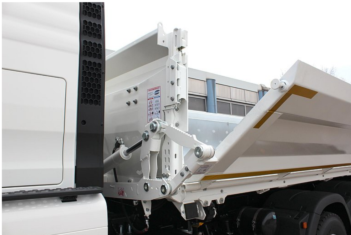
VOLITELNĚ: na levé straně Bordmatic = hydraulicky sklopná bočnice
