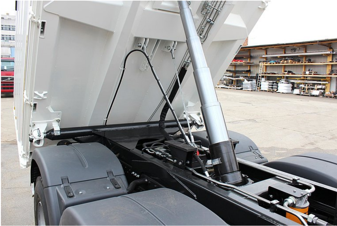
Tvrdě chromovaný, vysoce kvalitní hydraulický válec (hydromotor)
