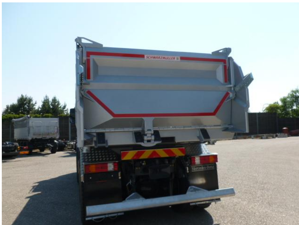
Zadní ocelová stěna tl. 4 mm, vysoká cca 980 mm, výkyvná se zvýšeným uložením čepů a s pneumatickým uzávěrem ovládaným z kabiny řidiče abklappbar
