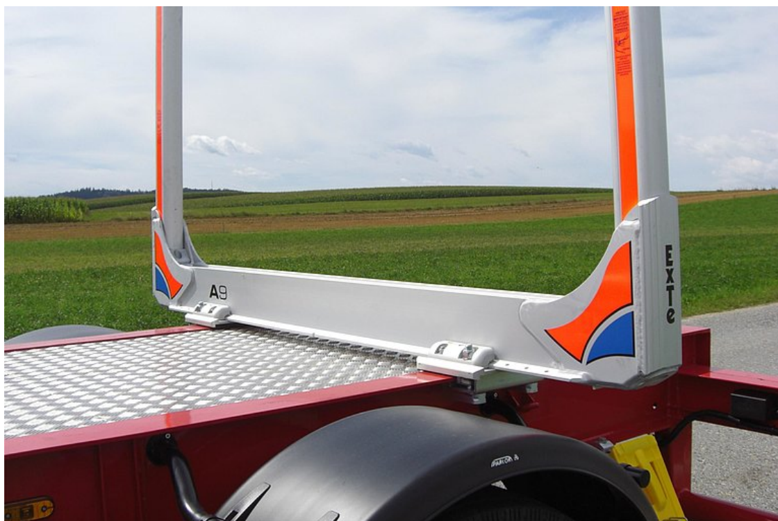
Exté kapsy pro klanice s 2-dílnými klanicemi Exté 144 se šroubovacím upevněním (zatížení 1 páru klanic max. 7 t)
