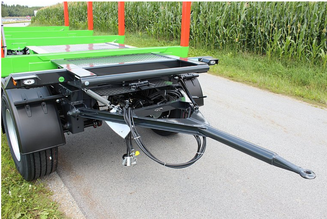
Vpředu otočný podvozek vč. namontované tažné oje
