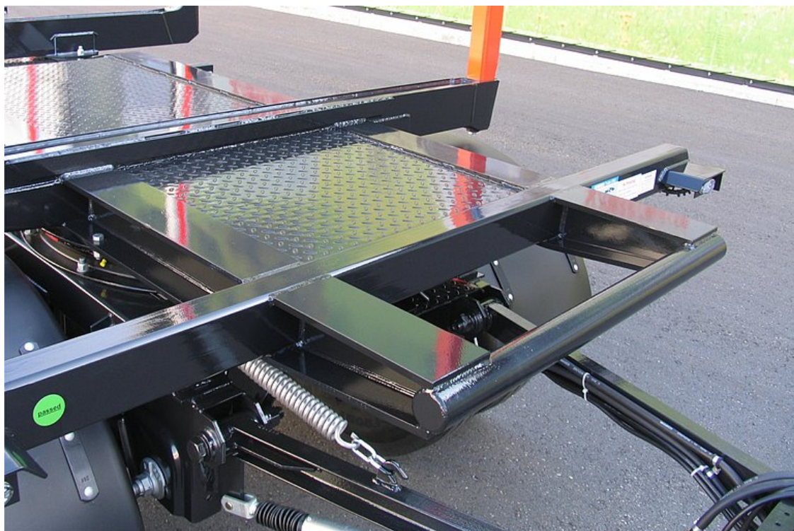
VOLITELNĚ: vpředu pevný třmen pro zvednutí nakládacím jeřábem, vč. zajištění točnice
