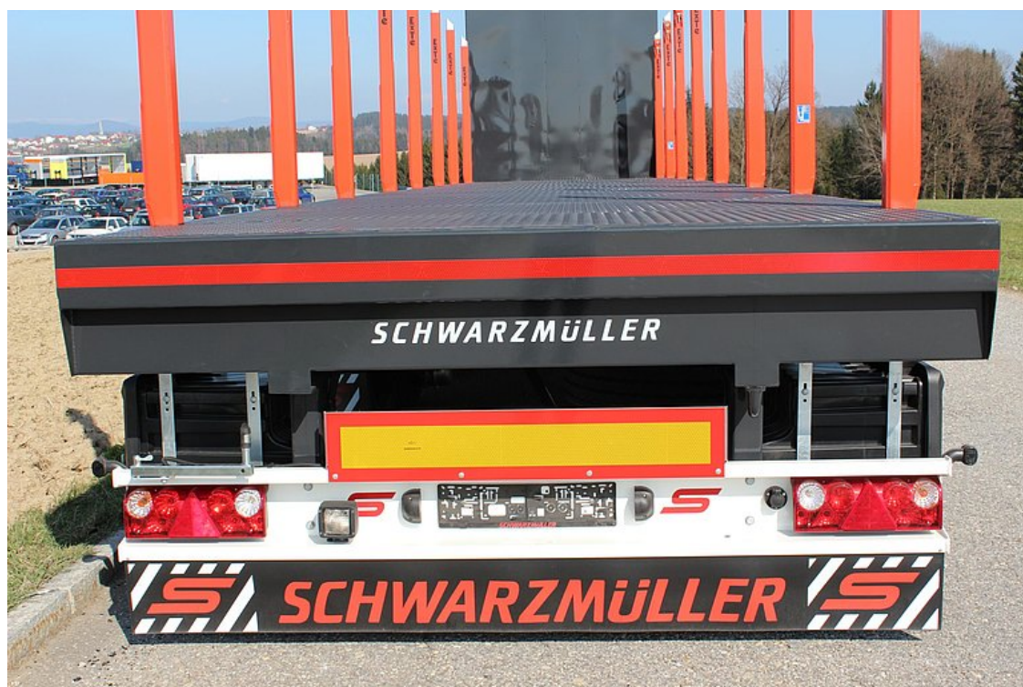
Zadní uzavírací plech vč. namontovaného hliníkového nárazníku
