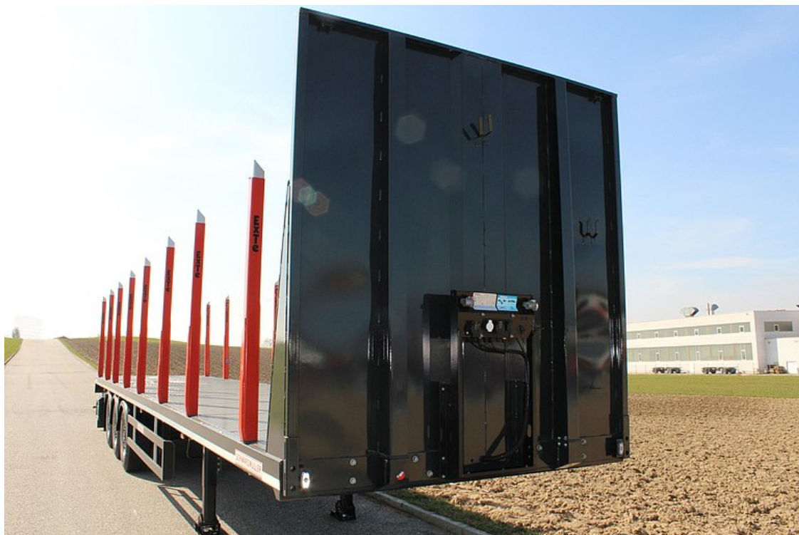
Extra silná ocelová přední stěna se středovými opěrami
