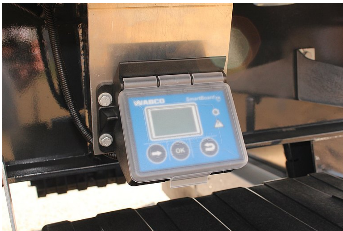
VOLITELNĚ: SmartBoard - zobrazovací a ovládací jednotka od firmy Wabco umístěná na vozidle= čtení údajů o provozu vozidla na displeji jednotky (stav km, zatížení náprav, atd.)
