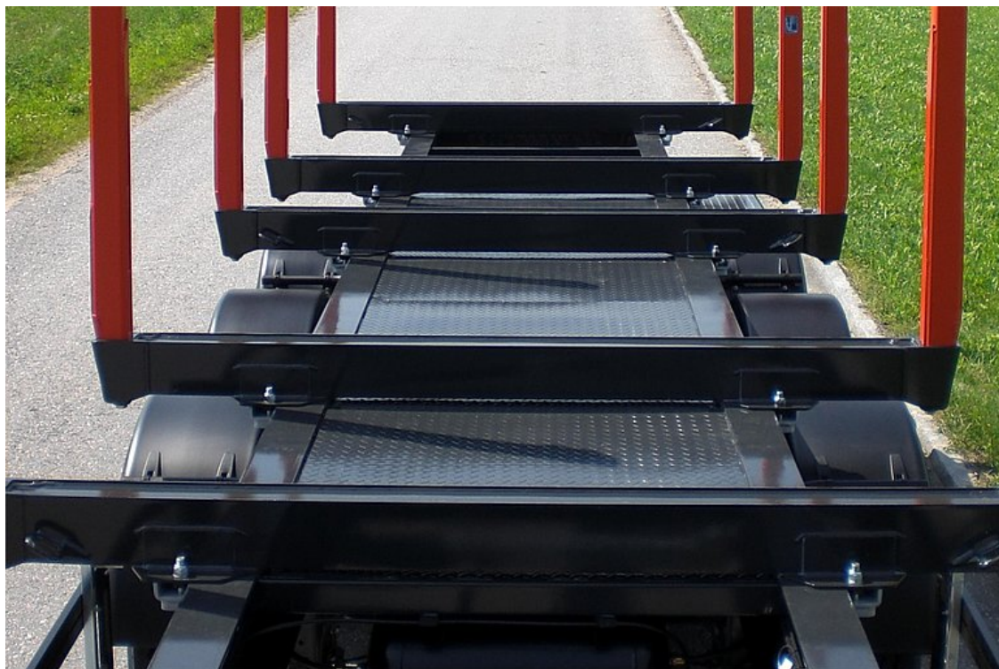
Překrytí z ocelového žebrovaného plechu mezi podélníky nad podvozkem a vpředu
