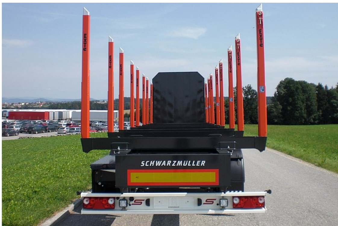
Zadní uzavírací plech vč. namontovaného hliníkového nárazníku
