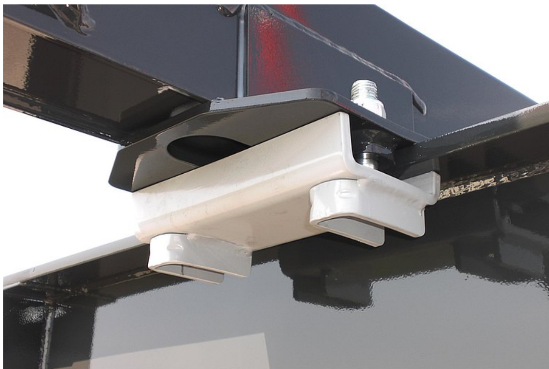
Klanicové příčníky vsazené prostřednictvím navařeného upínacího zařízení = přemístitelné
