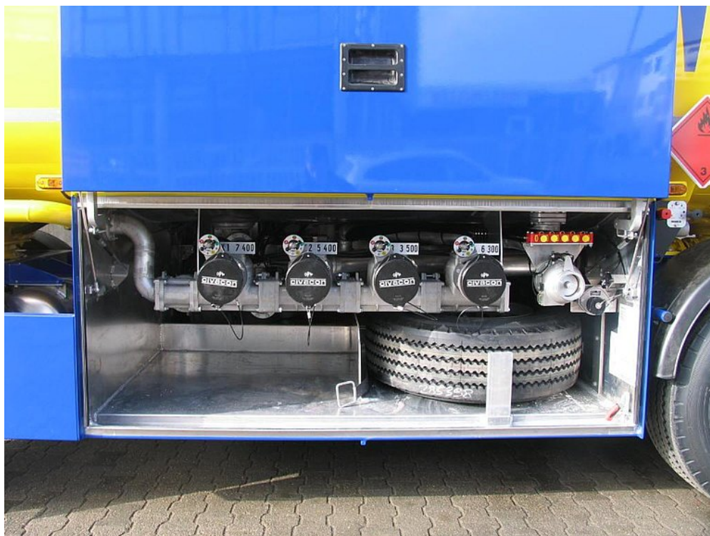
Přístrojová skříň s paralelně otevíraným víkem a s možností umístění jednoho rezervního kola
