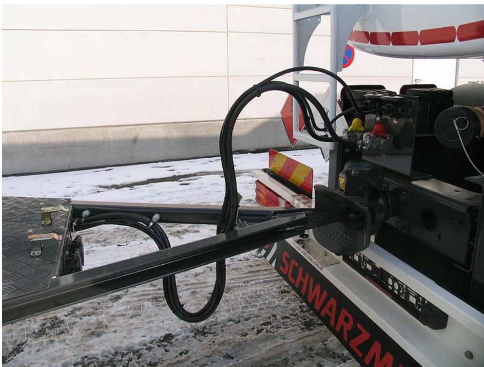
Tažná oj s propojovacím kabelem k tažnému vozidlu
