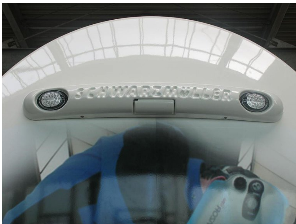
VOLITELNĚ: vysoko umístěný držák LED-světél s možností integrované zpětné kamery pro bezpečné couvání
