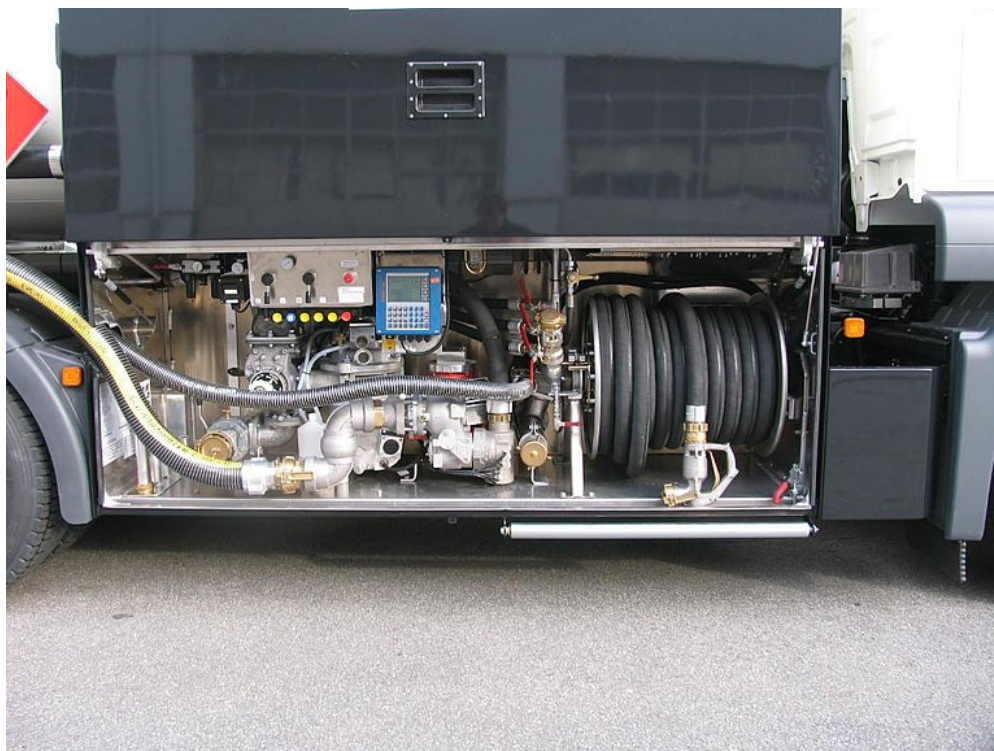
Přístrojová skříň s jednodílným paralelně otevíraným víkem
