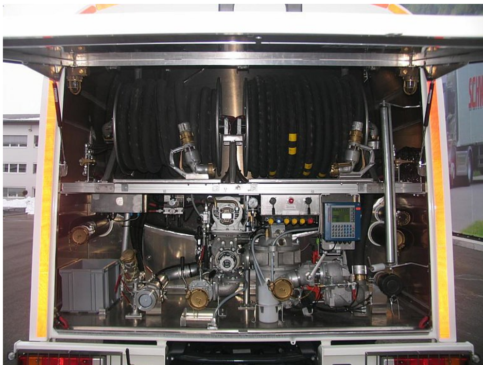
Zadní přístrojová skříň s vysoko výklopným víkem pro měřicí zařízení a hadicový buben
