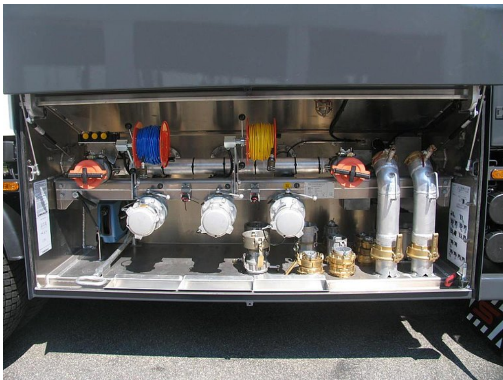
Přístrojová skříň s paralelně otevíraným víkem
