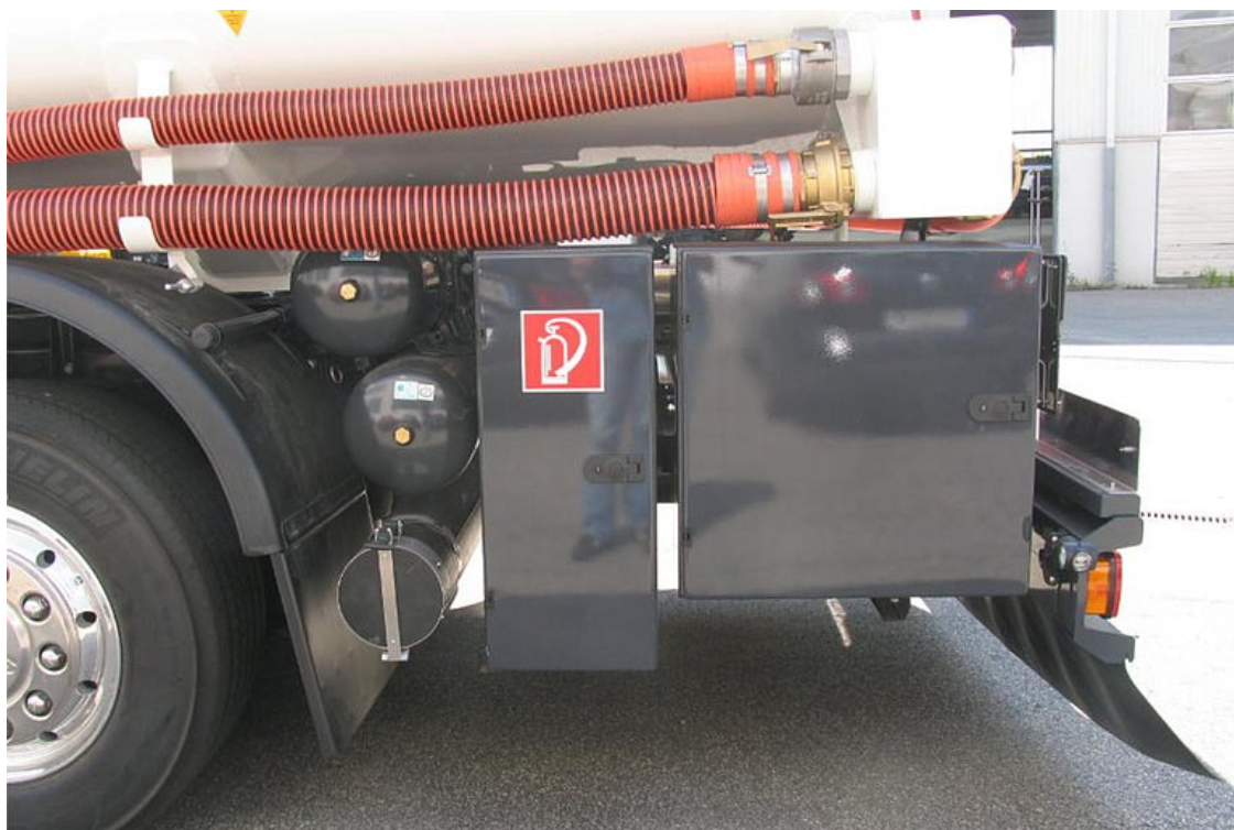
Hliníková schránka pro 12 kg hasicí přístroj a schránka na příslušenství
