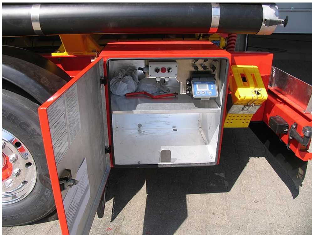
Schránka na příslušenství s víkem do strany otevíratelným nabízí dostatek odkládacího prostoru
