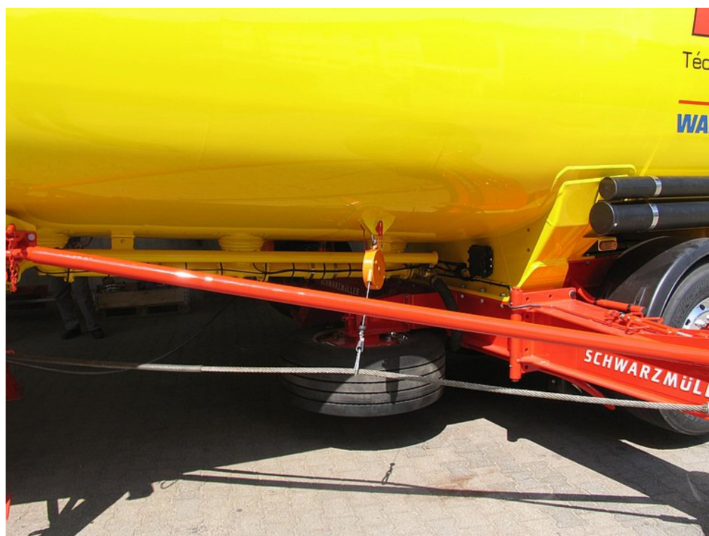
Napínací ochranná lana v oblasti vzpěry nádrže
