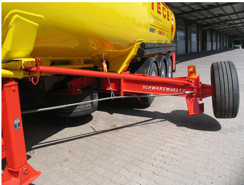
Vzpěrná ochrana vč. vzpěrných ochranných lan a otočného světla ve směru jízdy vlevo
