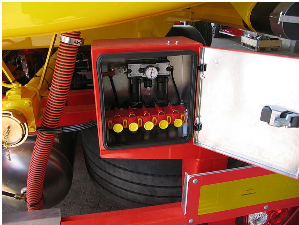
Schránka pro ochranu pneumaticky řízených ventilů
