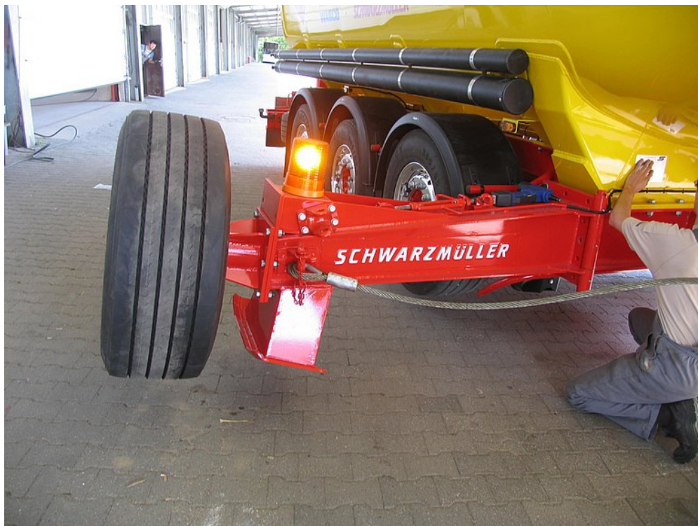
Vzpěrná ochrana vč. vzpěrných ochranných lan a otočného světla ve směru jízdy vpravo
