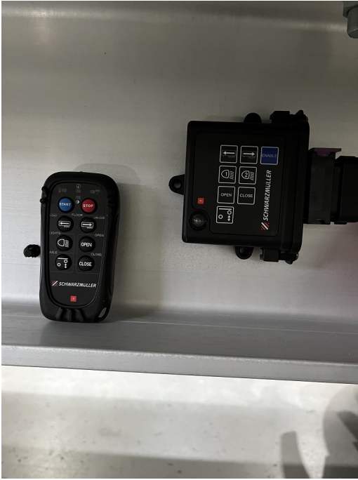
Rádiové dálkové ovládání s ovládáním pracovních světel nebo zvedací nápravy
