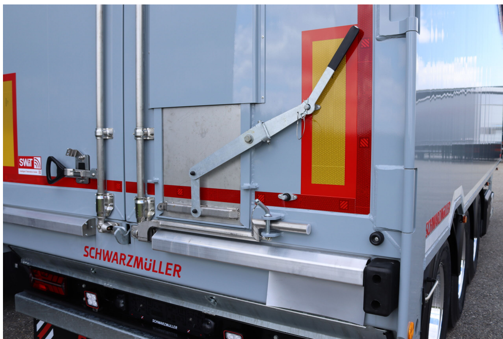
Ochranná deska plachty pro ochranu rolovací plachty během nakládání
