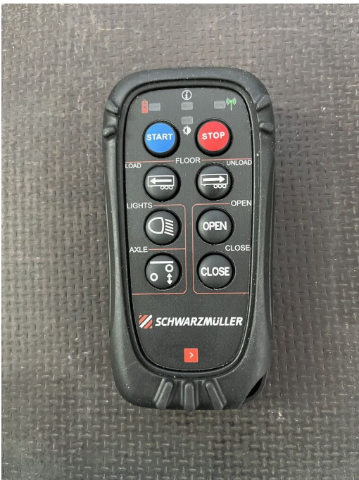
Rádiové dálkové ovládání s ovládáním pracovních světel nebo zvedací nápravy
