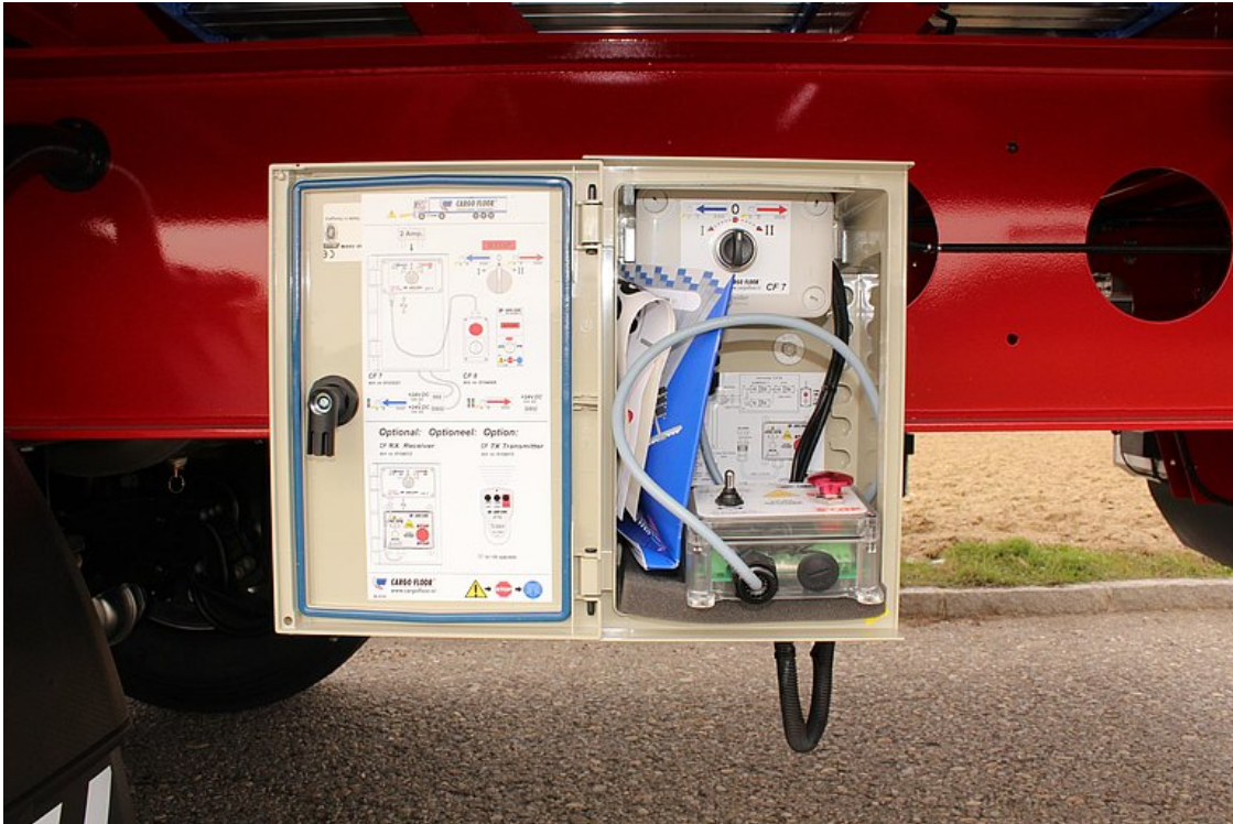
Ovládací jednotka posuvné podlahy ve vodotěsné schránce, rovněž s dodatečným dálkovým ovládním s 10 m kabelem
