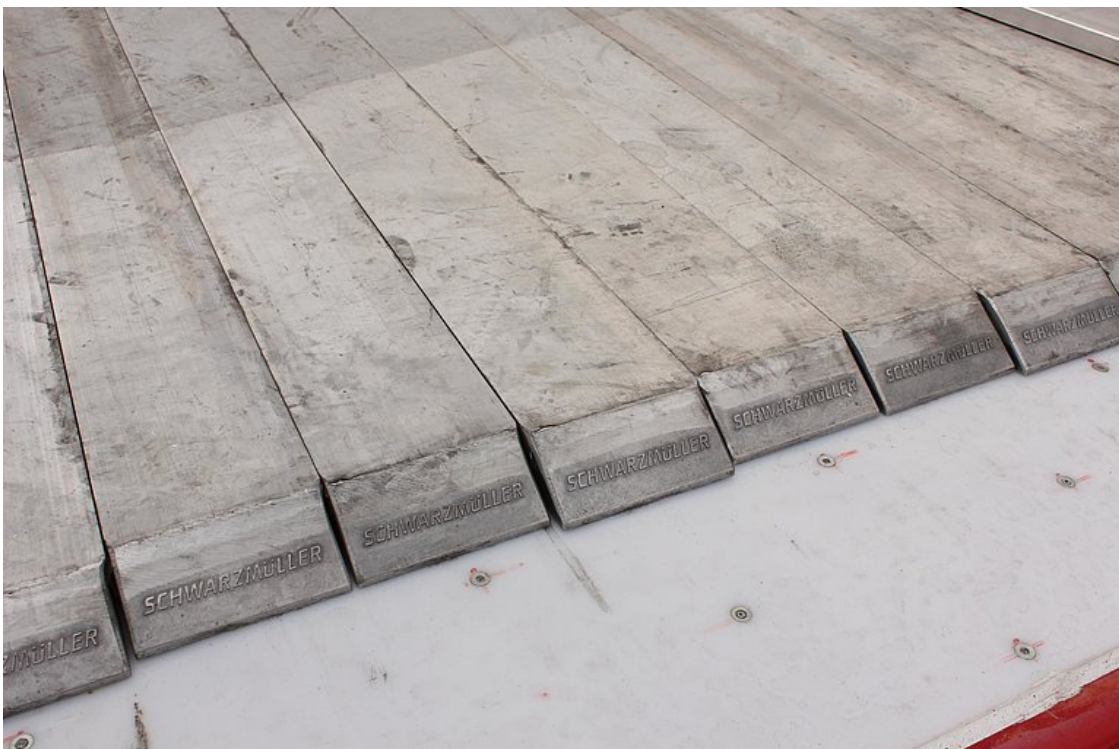
Hydraulicky posuvná podlaha, systém 21 hliníkových profilů pro nakládku a vykládku vozidla
