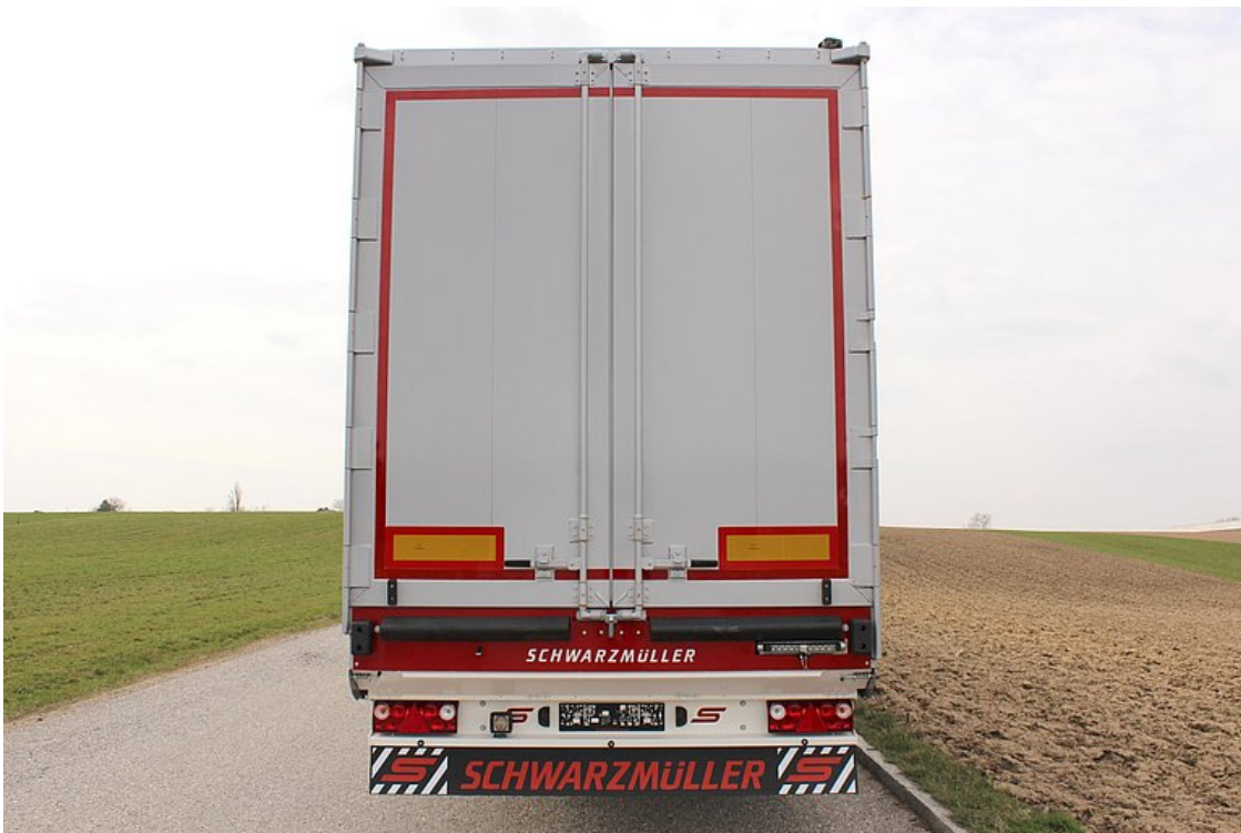
Zadní stěna = dvoukřídlá vrata s jedním vně uloženým otočným tyčovým uzávěrem v každém křídle a pneumaticky ovládaným pojistným uzávěrem
