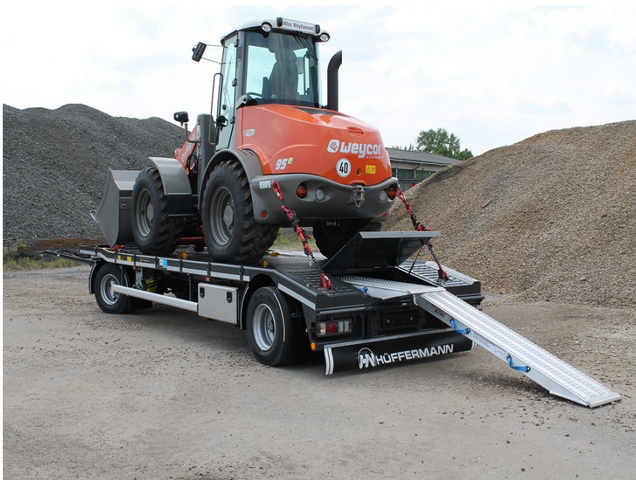
Zapuštěné a variabilně šroubovací přivazovací body ve vnějším rámu
