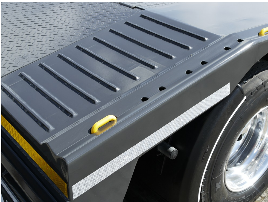
Zapuštěné a variabilně šroubovací přivazovací body ve vnějším rámu
