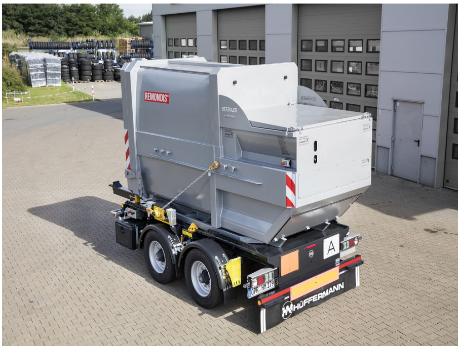
Zvláštní výbava uzavřená nakládací podlaha z ocelového plechu a SafetyFix
