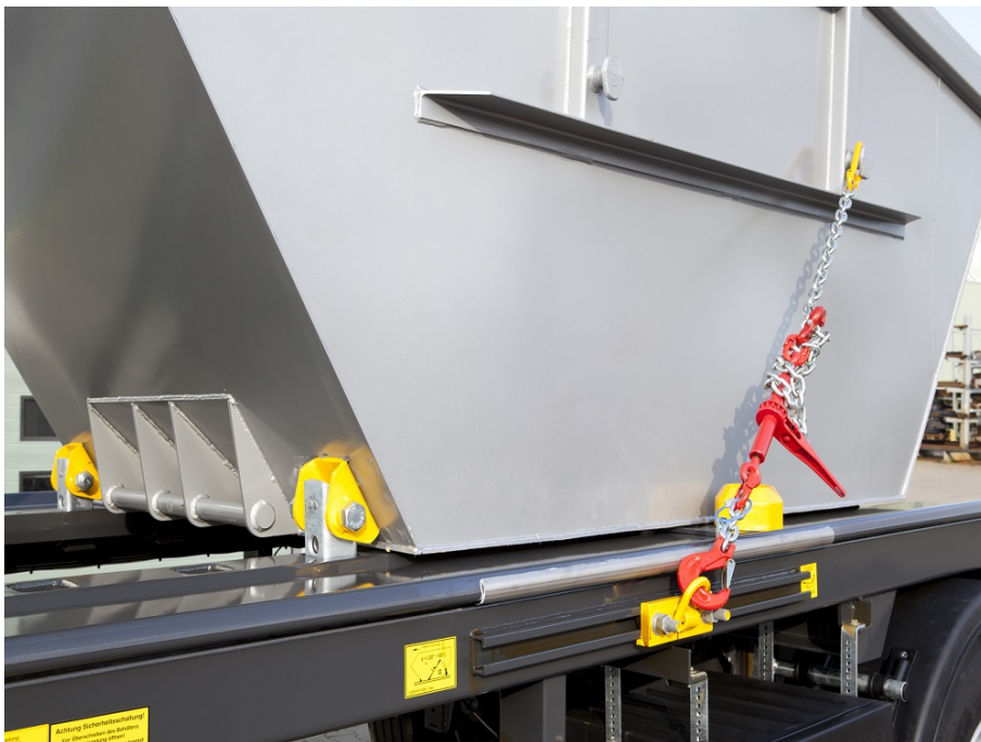
Kombinované zajištění nákladu pomocí Centrování-Fix a přivazovacích řetězů
