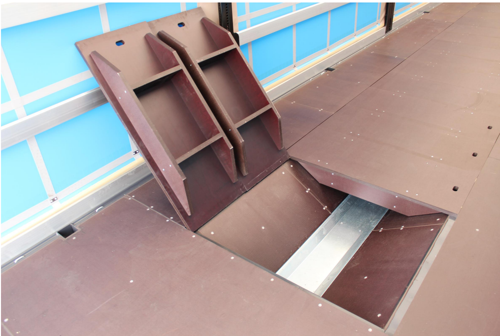
Prohloubené lůžko o užité délce cca 7.400 mm, s pěti páry integrovaných lůžek, průměr cívek až 2.100 mm
