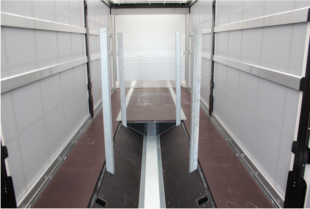
Prohloubené lůžko o užité délce cca 7.400 mm, s pěti páry integrovaných lůžek, průměr cívek až 2.100 mm
